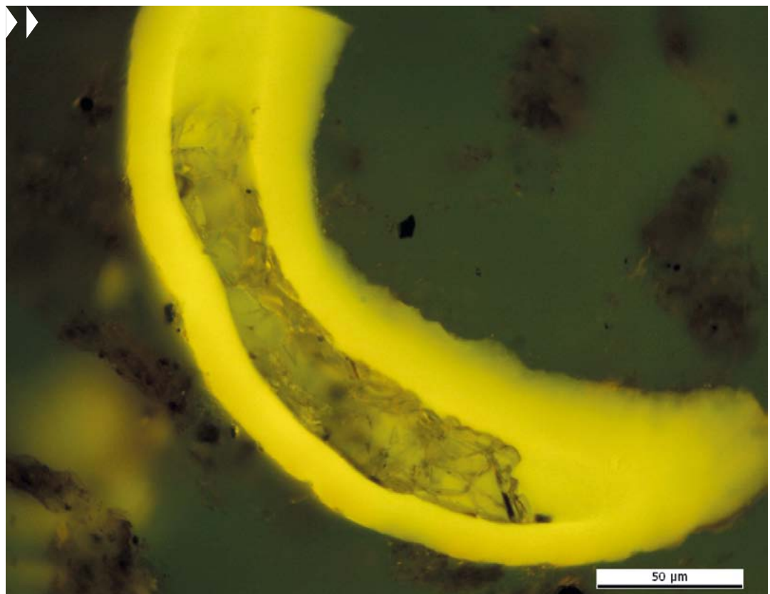
Offene Pore in organischer Hülle in einem Tonschiefer (Mikroskopische Aufnahme unter Fluoreszenzlicht)
