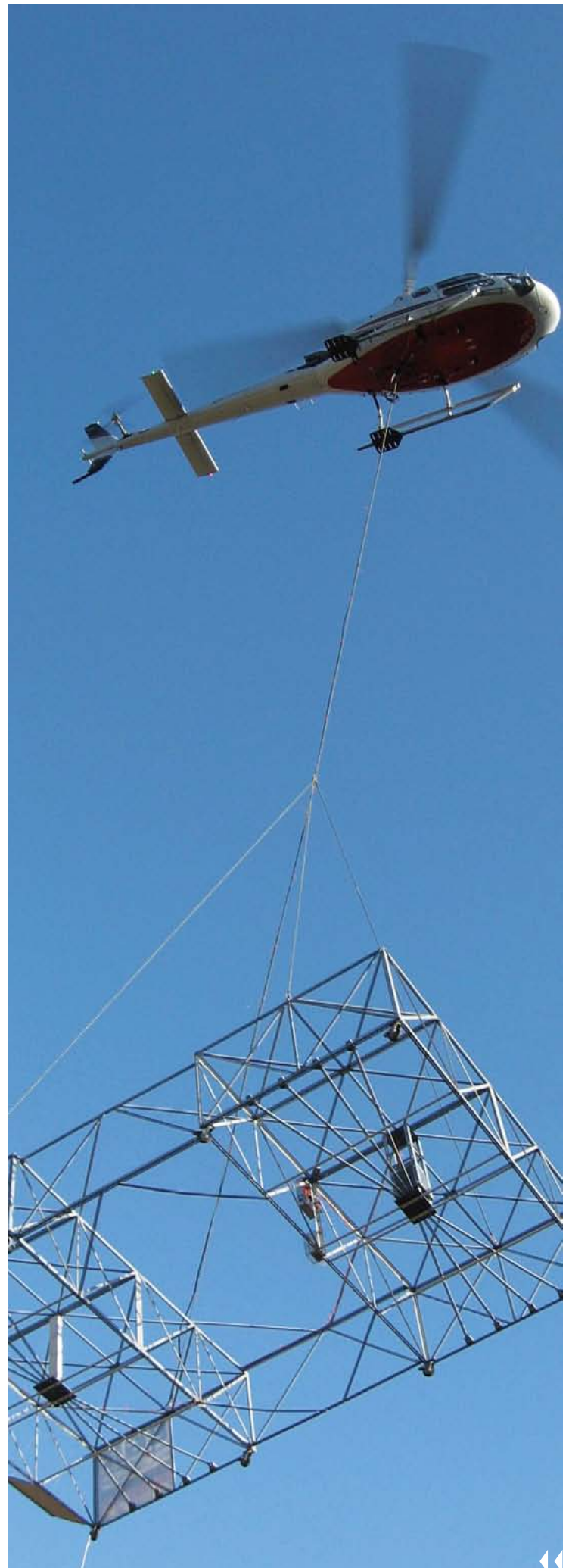
Aero-Georadar: Sende- und Empfangsantenne hängen unter dem Hubschrauber
