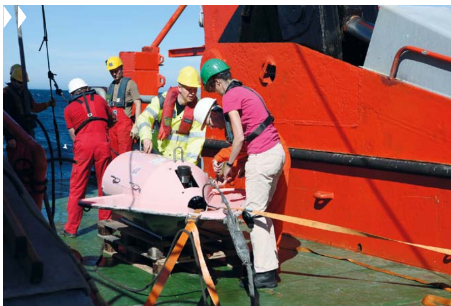
CSEM Einsatz vor Neuseeland. Das „Pig“ ist eine pfeilförmige Tonne hinter dem die Messkette des CSEM Systems am Meeresboden geschleppt wird. Bevor es ins Wasser geht werden letzte Handgriffe angelegt.
