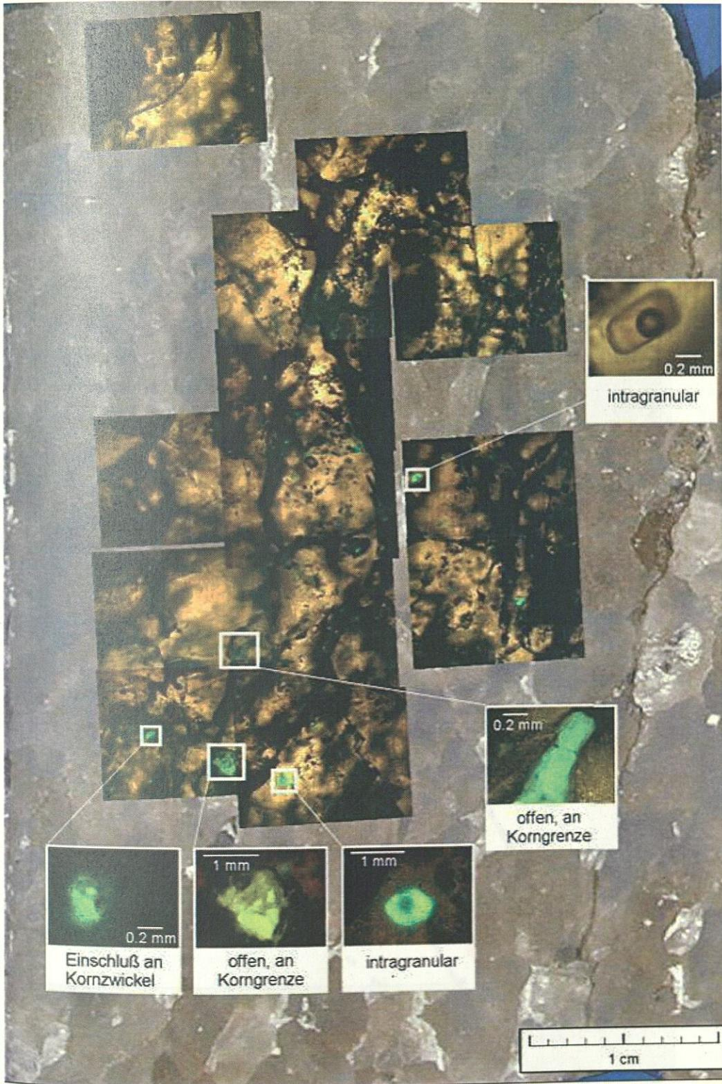
Abb. 3: Verteilung von KW-Einschlüssen in einem Dickschliff (Durchlicht, UV-Licht), Gorleben-Steinsalz, Handstück aus Querschlag 1 West, z2HS1 (POPP et al. 2002)
