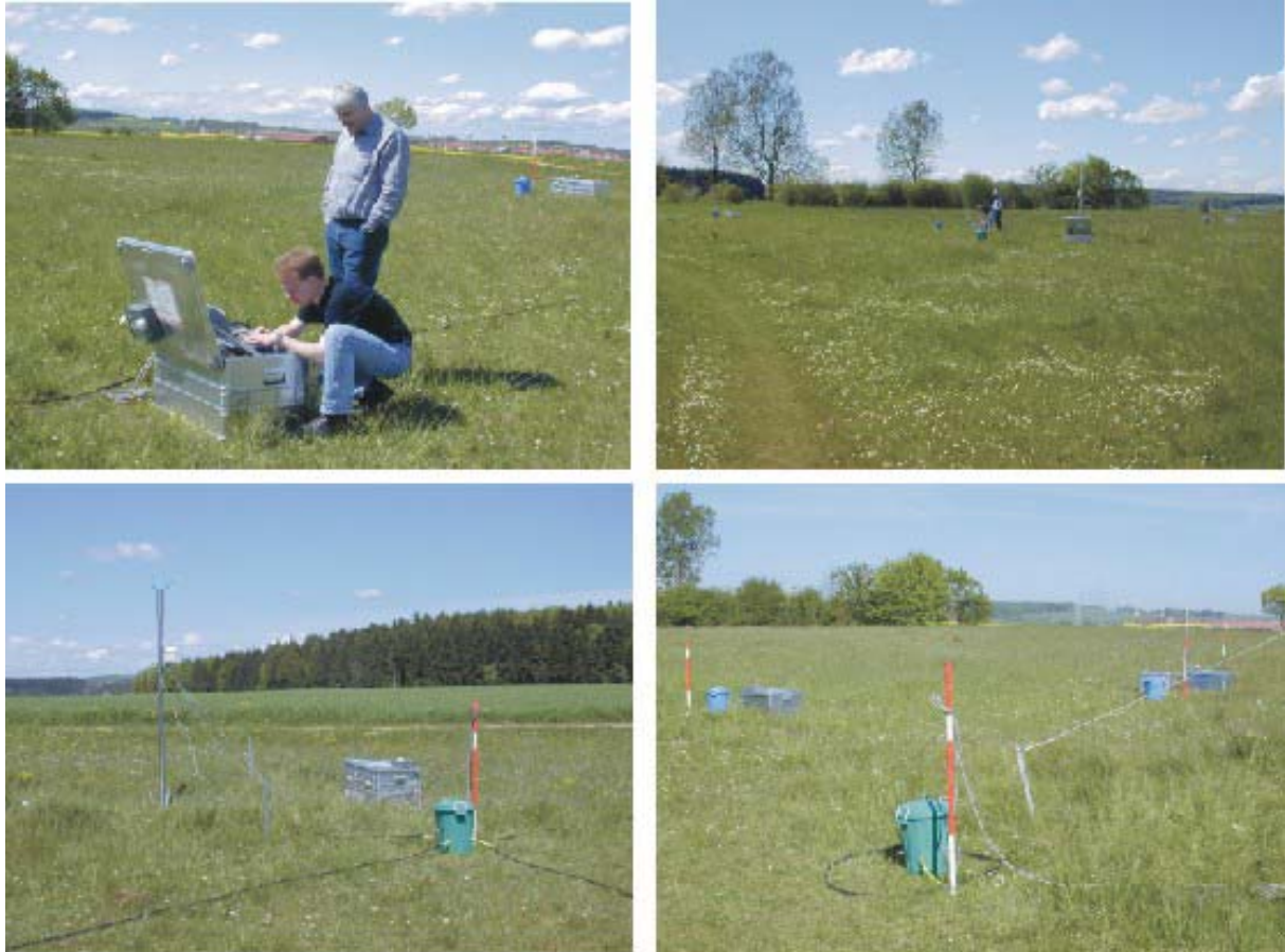
Abbildung 4: Überblick über das Messgebiet und die eingesetzten mobilen Messgeräte. Oben links: Vorbereitung der in Aluminiumkontainern untergebrachten Datenerfassungssysteme für die Messung. Oben rechts: Blick auf das Messgebiet in Richtung Westen. Unten links: Referenzstation mit Wetterstation und sternförmig angeordneten porösen Schläuchen zur Reduzierung des Windrauschens. Rechts unten: Kleine Dreiecksanordnung der Mobilstationen mit ringförmigen Schläuchen. In den grünen Plastikkeimern befinden sich jeweils die Mikrobarographen.
