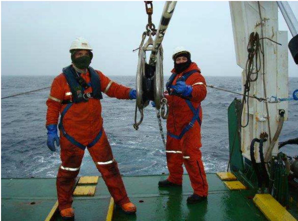
Unsere Kollegen Thomas und Gerhard bringen den Streamer (das 3600 Meter lange Messkabel) ins Wasser. Jeder, der auf dem Arbeitsdeck arbeitet, trägt eine Arbeitsschwimmweste. Wer sich an der geöffneten Heckpforte aufhält, ist zusätzlich durch eine Sicherheitsleine abgesichert.
