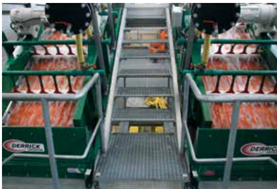
Spezielsiebmaschinen zur Korngrößenfraktionierung von Quarzsand, Foto: Schlingmeier Quarzsand GmbH & Co. KG (mit frdl. Genehmigung).
