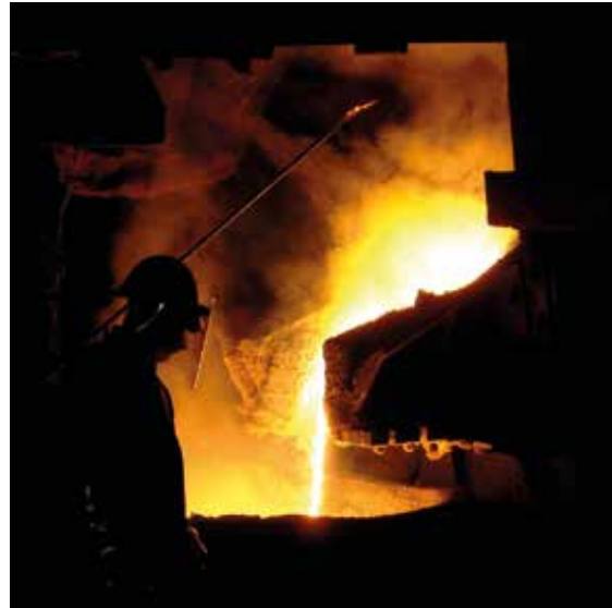
Abstich von glutflüssigem Ferrosilizium bei der ASK Chemicals Metallurgy GmbH, Foto: BGR.
