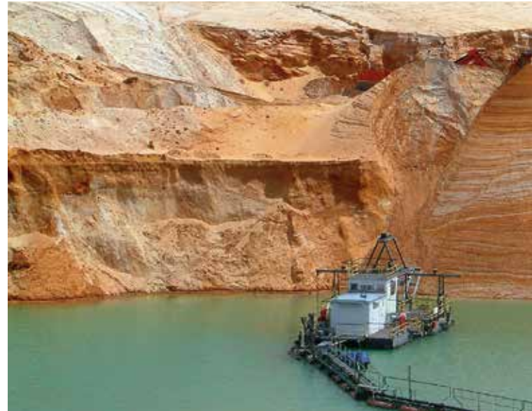
Sandgewinnung mittels Saugbaggerschiff im Quarzsandwerk Gambach der Quarzwerke GmbH, Foto: BGR.
