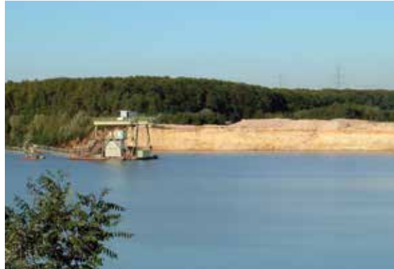
Die Kaspar Weiss GmbH & Co. KG gewinnt mittels Schwimmgreifer am Stadtrand von Rodgau quarzreiche Kiessande eines früheren Mains, Foto: BGR.
