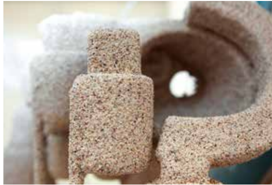
Eine mehrlagige Schicht auf Quarzsandbasis auf einem ausschmelzbaren Wachsmodell bildet eine Formmaske aus, die zum Guss hochgenauer Gussteile in Großserien dient, Foto: Andreas Bednarek (mit frdl. Genehmigung).
