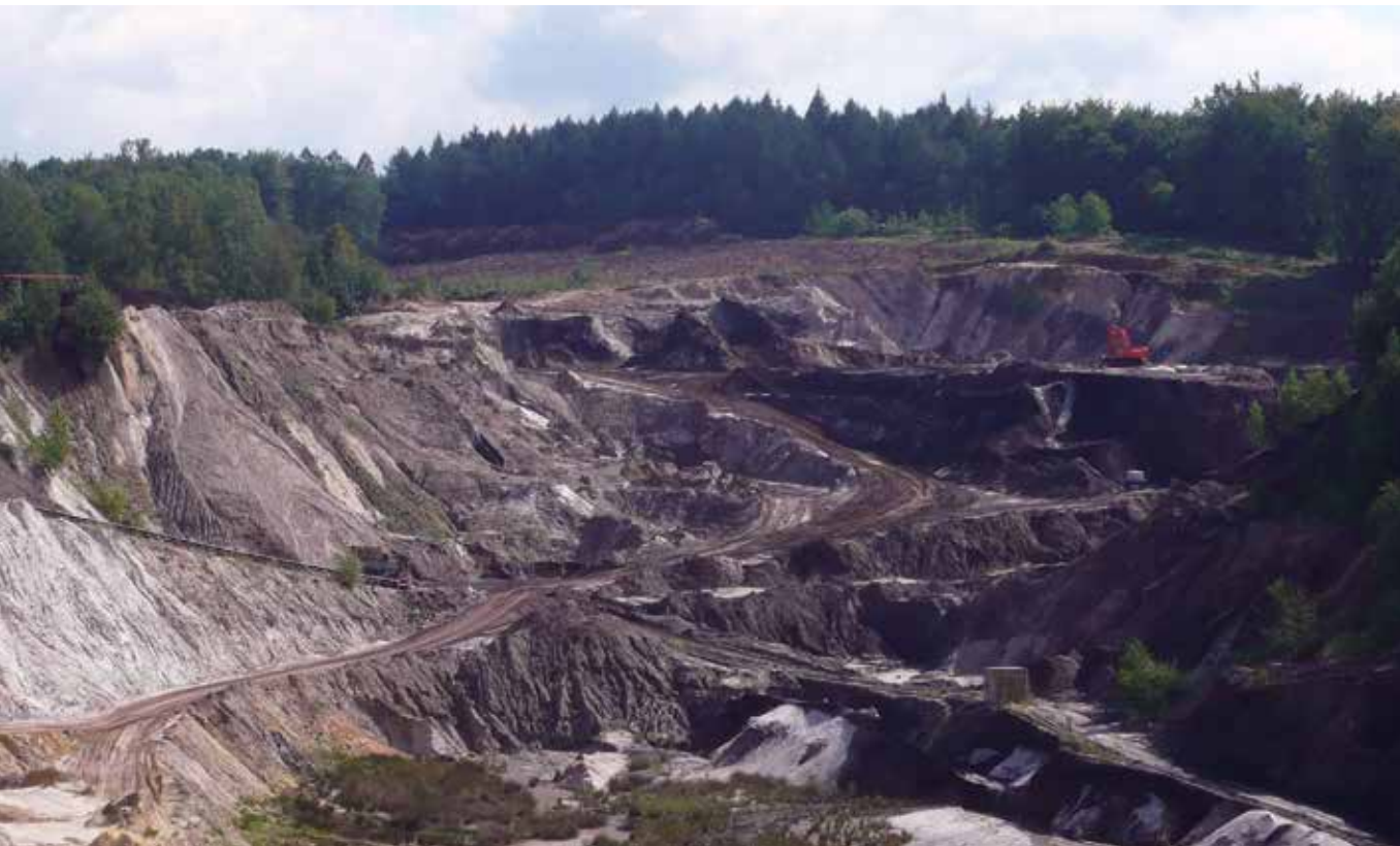
Gewinnung von Quarzsand zwischen Braunkohleflözen bei Duingen, Foto: Dörentrup Quarz GmbH & Co. KG (mit frdl. Genehmigung).
