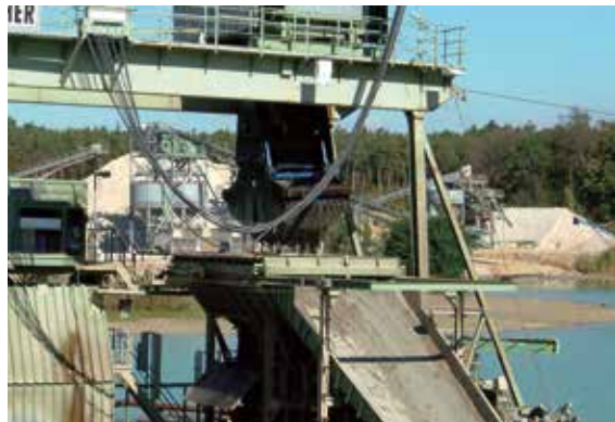
Auch in Raunheim fördert ein Schwimmgreifer Sande für die Industriesandproduktion im angeschlossenen Quarzsandwerk, Foto: BGR.
