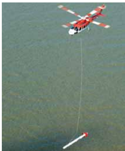
BGR-Hubschrauber mit der Flugsonde im Messeinsatz über der Nordseeküste.
