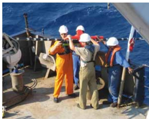
Aussetzen des Streamers bei marin-seismischen Erkundungen am Kontinentrand vor Mosambik.
