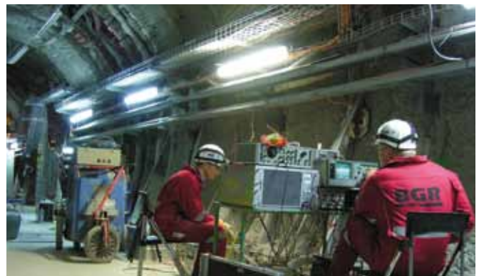
Mit seismischen Messungen wird das Gebirge im Untertage-Forschungslabor Meuse / Haute-Marne in Frankreich charakterisiert.
