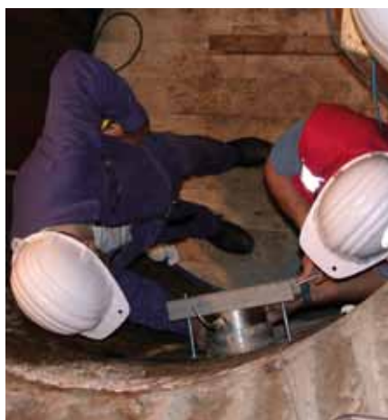
In-situ Oberflächenpackertest zur Ermittlung der Durchlässigkeit von Granit.
