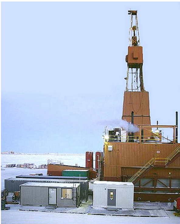
Abb. 9: Gashydrat-Forschungsbohrung in der Arktis (Doyon 14 Bohrturm, Milne Point Feld, Alaska. Foto: National Energy and Technology Laboratory)
