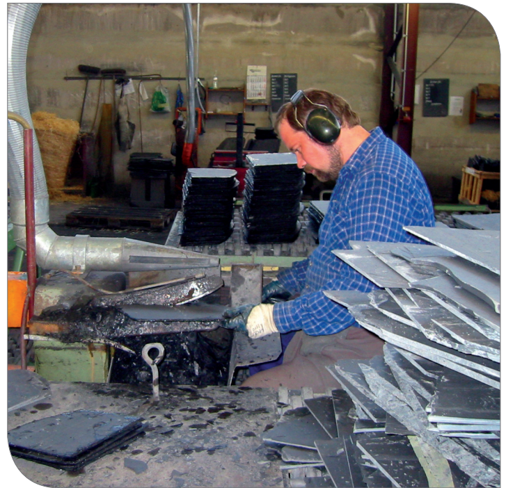
Abb. 3: Zuschnitt von Dachschiefen im Natursteinwerk Schmie-debach/Thüringen, Foto: BGR.
