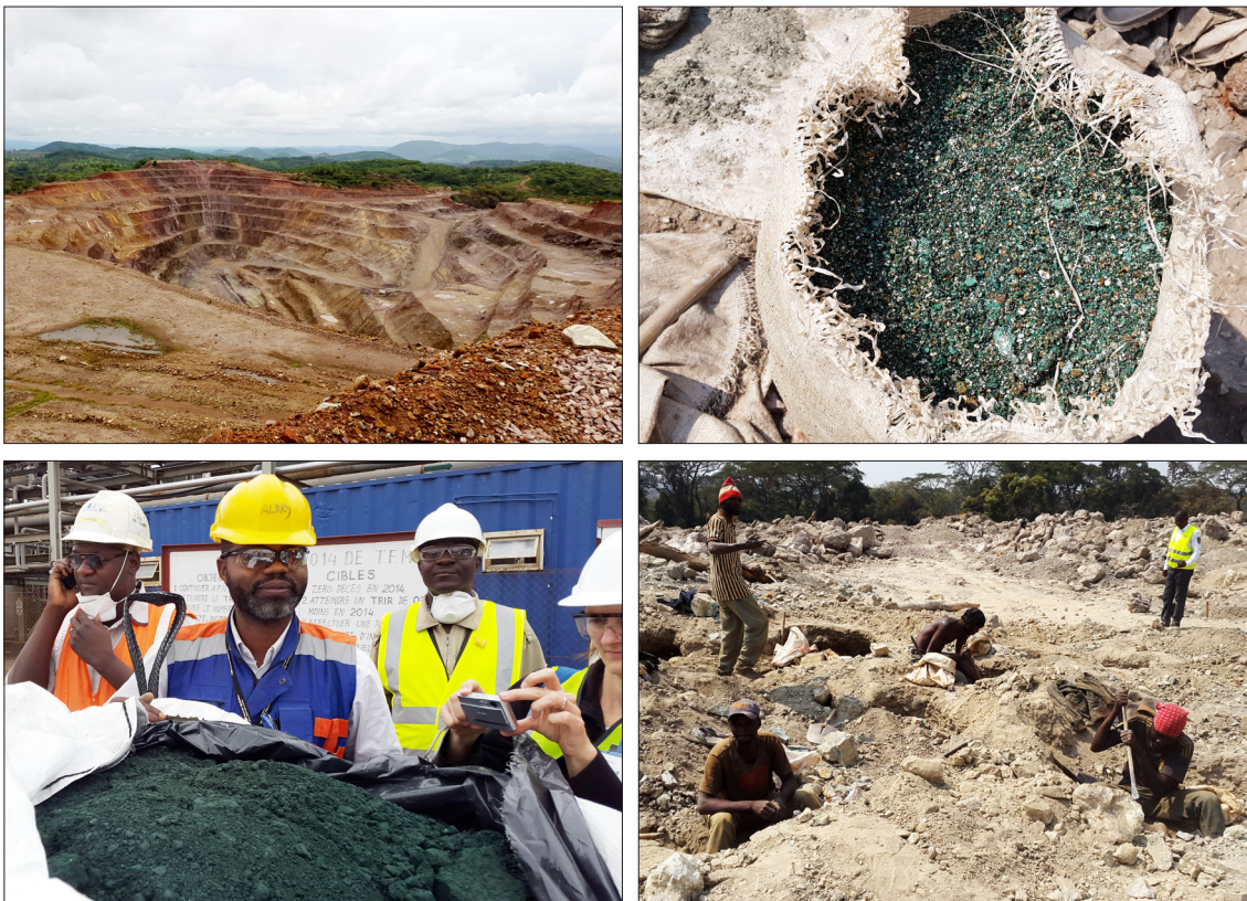
Abb. 7: Industrieller (links) und artisanaler (rechts) Bergbau auf Kupfer und Kobalt in der DR Kongo und dessen Produkte Kobalhydroxid und Kobalt-Kupferkonzentrat. Der industrielle Abbau zeigt die Kwatebala Grube auf Tenke Fungurume, Haut Katanga Provinz. Die artisanale Gewinnung erfolgt in der Kamwale Mine, Lualaba Provinz (Fotos: BGR).
