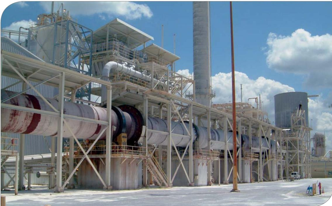
**Abb. 2:** In langen Drehrohröfen im BASF-Werk Edgar wird der Kaolin kalziniert, d. h. gebrannt. Die Kalzinierung erhöht den Weißgrad und die Härte, verbessert die elektrischen Eigenschaften und verändert Größe und Form der Kaolinteilchen, Foto: BGR.
