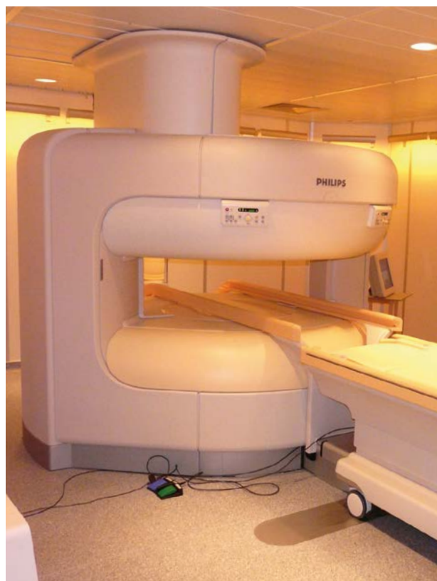
Abb. 2: Hochmoderner offener Magnetresonanztomograph (MRT) in der Klinik für diagnostische Radiologie des Universitätsklinikums Magdeburg. Seine Kühlung erfolgt mit flüssigem Helium Foto: (Julian Jürgens/Wikipedia).
