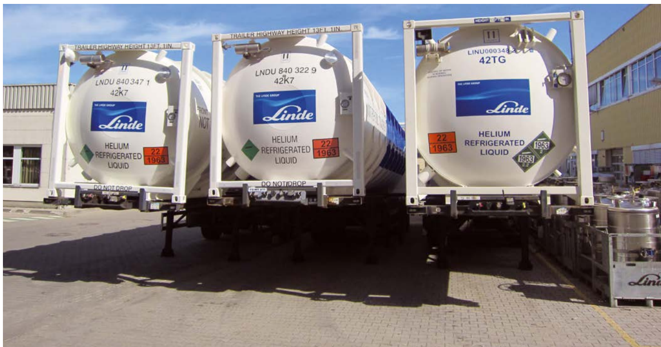
Abb. 1: Spezielle Kühlcontainer zum Transport von jeweils bis zu 41.600 l flüssigem Helium im Werk Unterschleißheim der Linde plc. Technisch handelt es sich um mehrwandige, unter 5,2 bar Druck stehende Container aus Edelstahl, bei denen zudem der äußere Schutzmantel durch flüssigen Stickstoff gekühlt wird (Foto: BGR).
