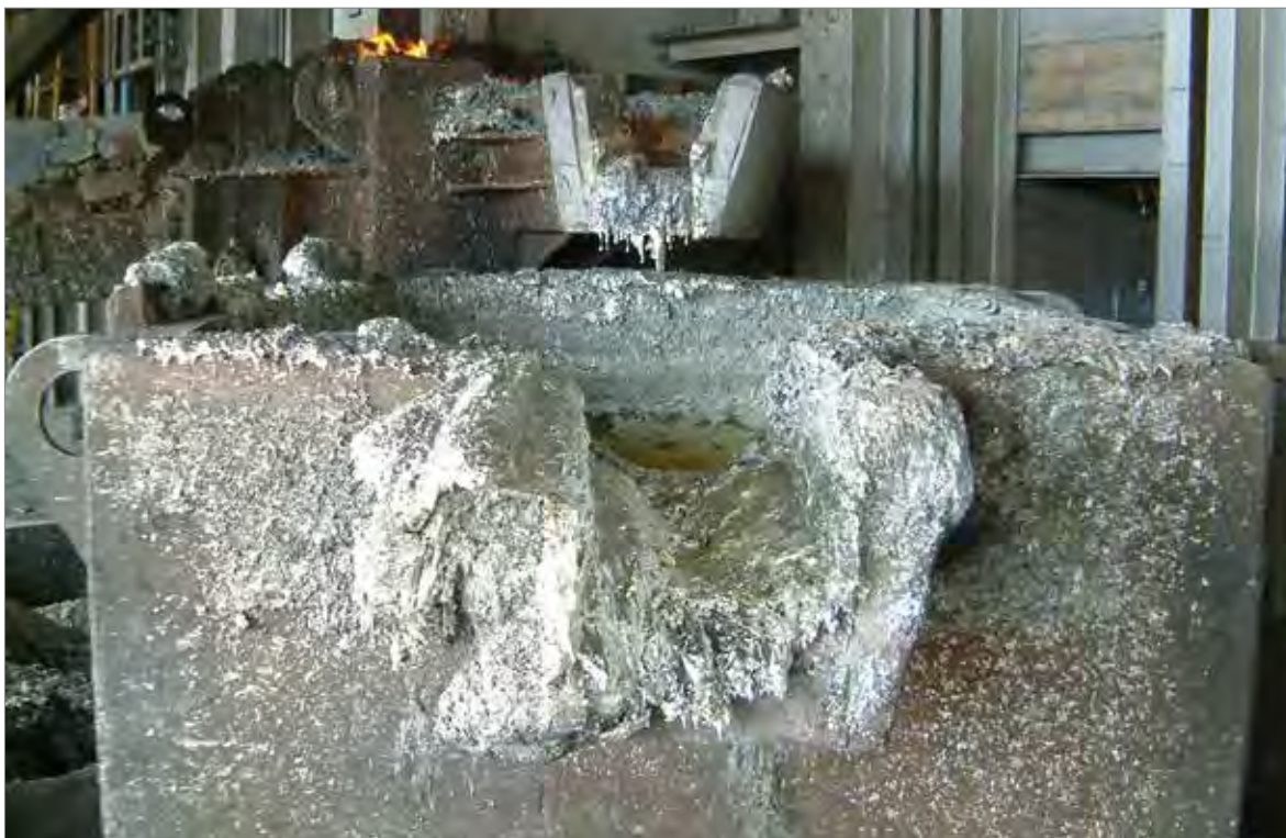
Abbildung 35: Zinngusswanne in der Schmelze von PT Timah in Mentok. Foto: BGR.
