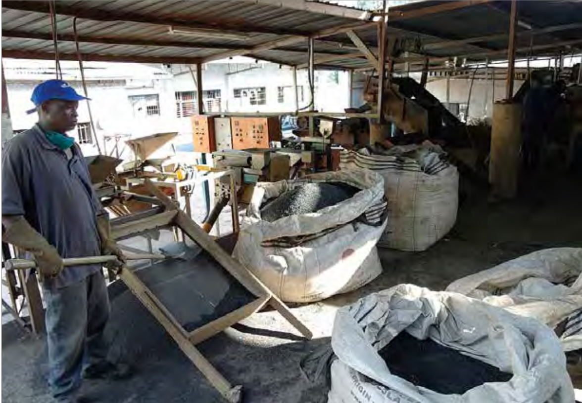
Abbildung 58: Aufkonzentration angelieferter Cassiteritkonzentrate in der Gisenyi Zinnschmelze. Foto: BGR.
