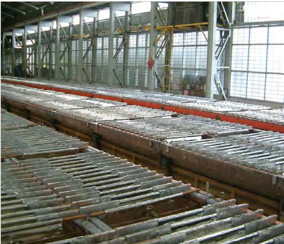
Abbildung 1: Elektrolytische Veredelung von Rohzinn in der Zinnschmelze von PT Timah in Mentok, Bangka Island, Indonesien. Foto: BGR.
