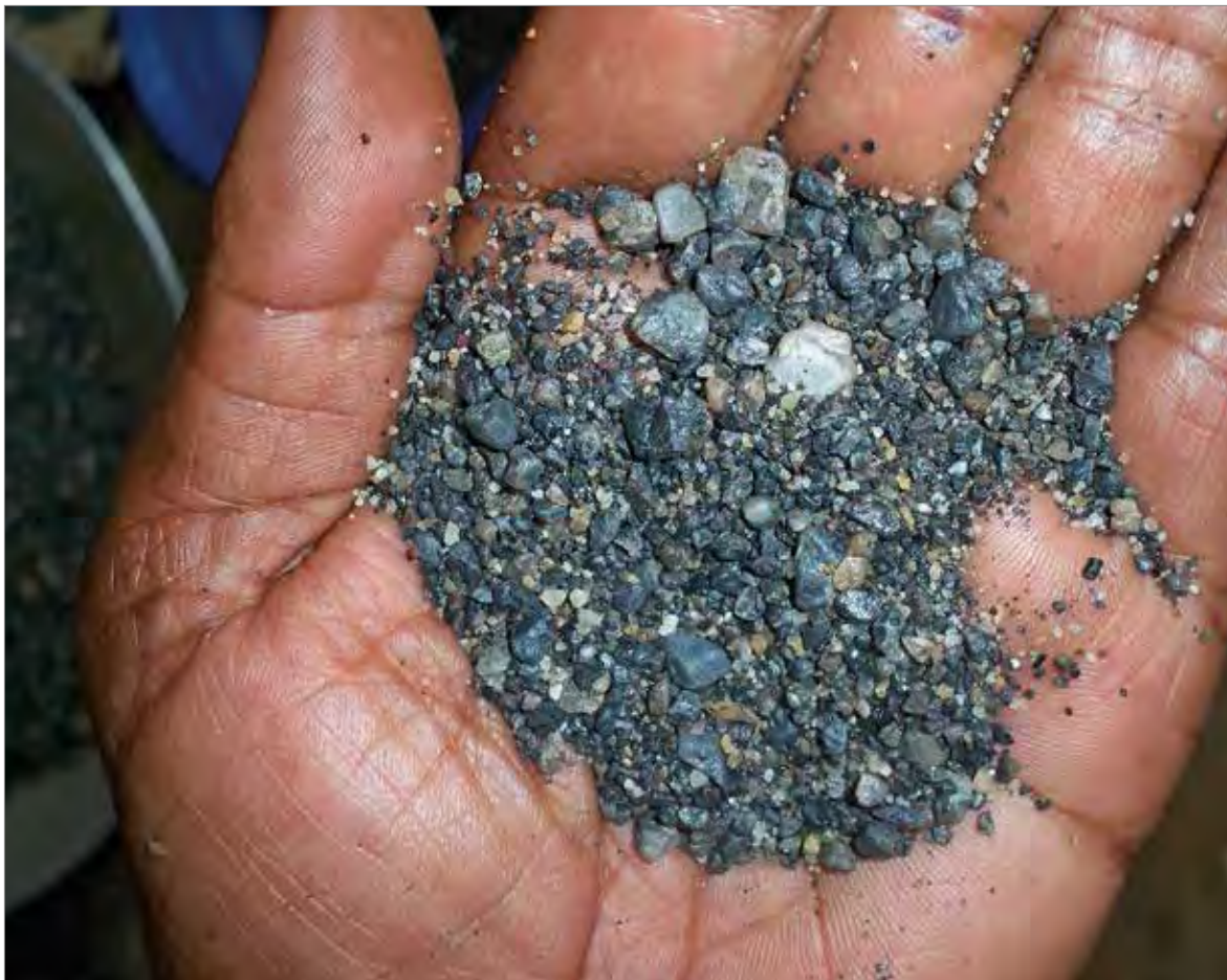
Abbildung 2: Im Kleinbergbau gewonnenes Cassiteritkonzentrat aus der DR Kongo. Foto: BGR.
