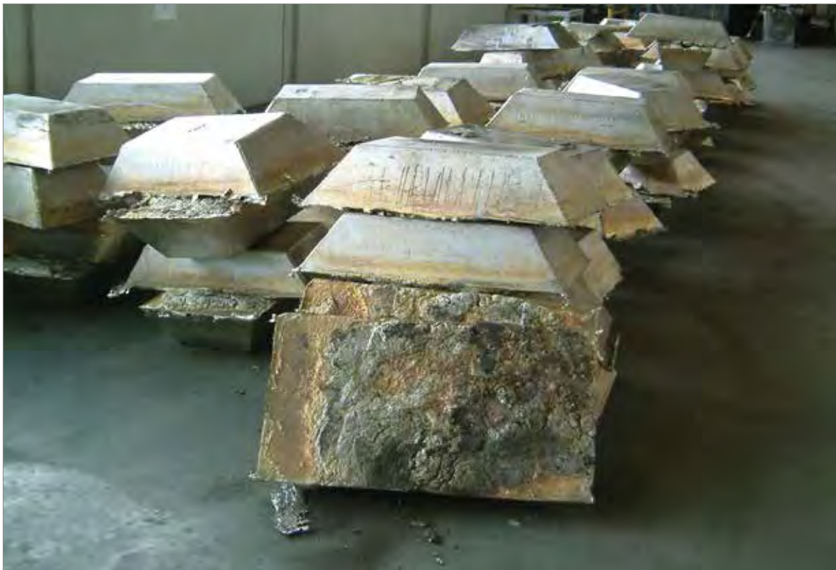
Abbildung 12: Rohzinnbarren in der Zinnschmelze von PT Timah in Mentok, Bangka Island, Indonesien. Foto: BGR.
