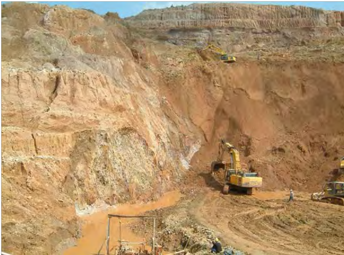
Abbildung 34: Abraumgewinnung durch einen Subkontraktor von PT Timah zur Freilegung einer Cassiteritgangergzlagerstätte (links im Bild) im Nordwesten von Bangka. In der nahe gelegenen Aufbereitungsanlage wird ein Zinnsteinkonzentrat mit durchschnittlich 53 % Sn-Gehalt produziert, das dann in der Hauptzinnschmelze von PT Timah in Mentok verhüttet wird. Foto: BGR.
