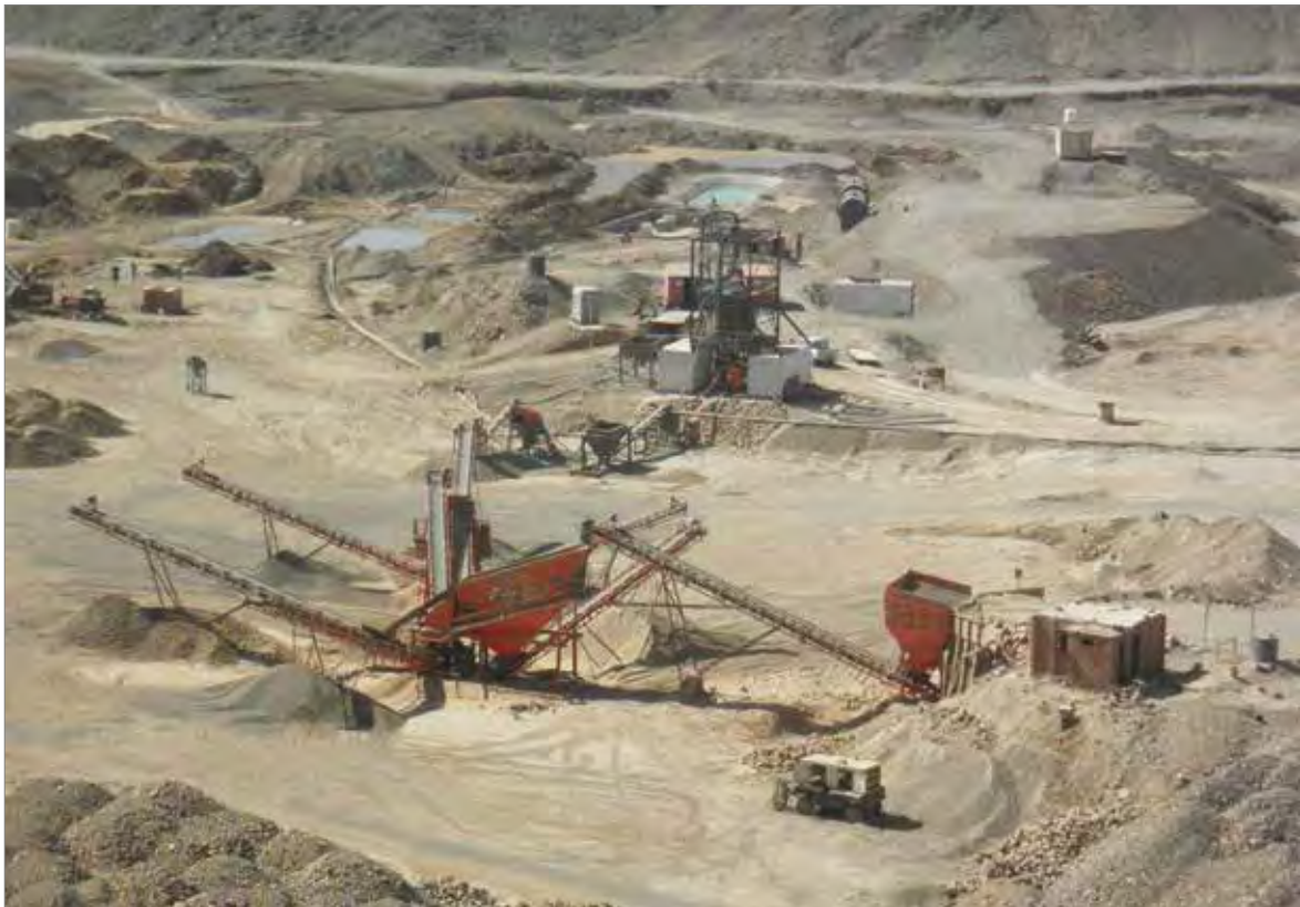
Abbildung 17: Gewinnung von Cassiterit aus fossilen Flusseifen, Projekt Abu Dabbab Alluvial, Ägypten, Foto: Gippsland Ltd. Quelle: BGR
