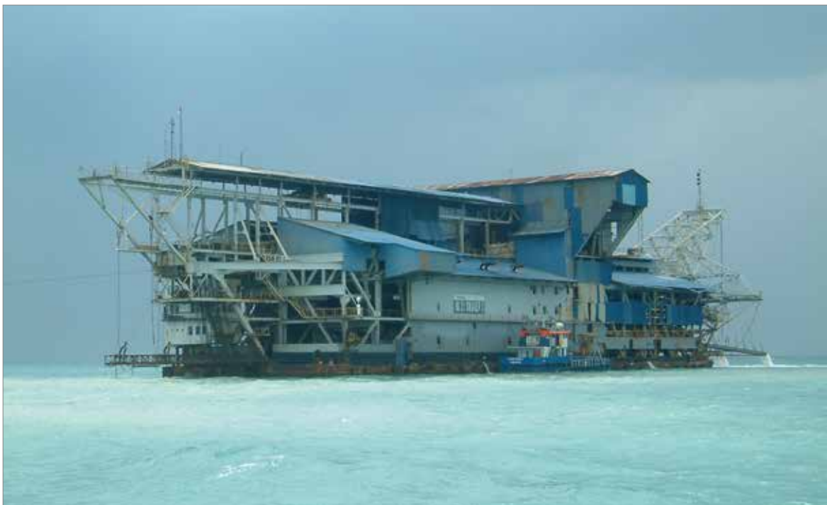
Abbildung 5: Schwimmender Eimerkettenbagger von PT Timah in den dort 30 m tiefen Gewässern vor Bangka Island, Indonesien. In Abbau steht unter bis zu 10 m Abraum eine 8 – 10 m mächtige, tonreiche, fossile Flussschneise. Eine Gewinnung von Zinnseifen in noch größerer Wassertiefe ist derzeit zwar technisch, aber nicht wirtschaftlich möglich. Quelle: BGR
