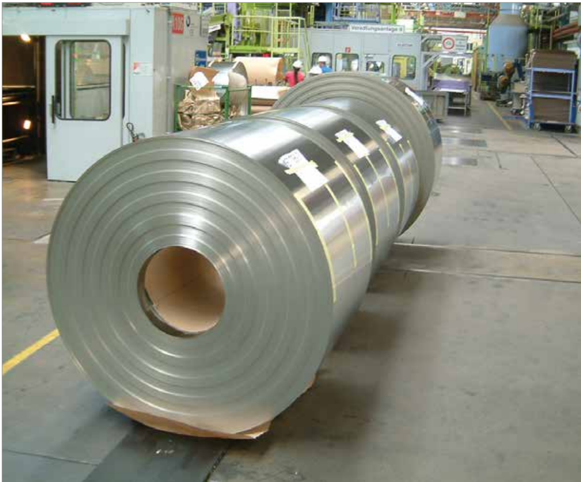
Abbildung 4: Verzinnete Weißblechcoils bei der ThyssenKrupp Rasselstein GmbH, Andernach. Foto: BGR.
