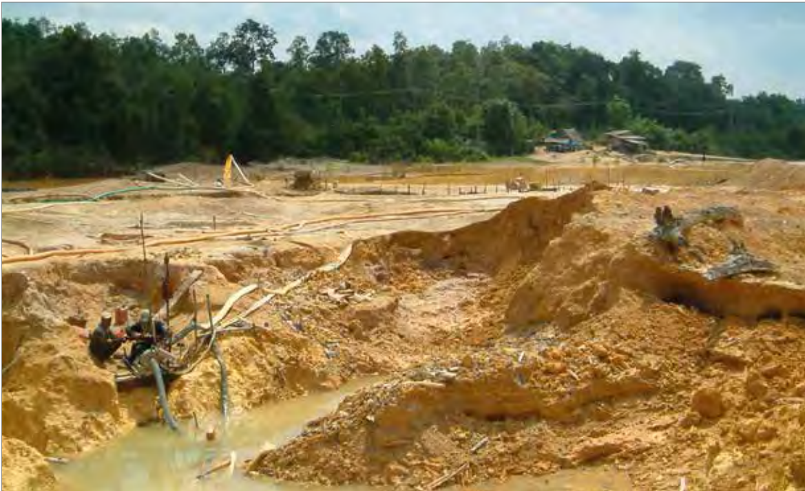
Abbildung 14: Gewinnung von Seifenzinn mittels „gravel pump“ durch Kleinbergleute („unconventional miners“) auf Bangka Island. Eine Rekultivierung findet nicht statt. Foto: BGR.
