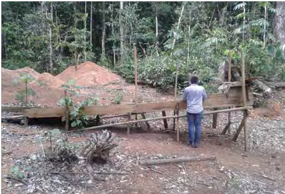
Abbildung 41: Primitive Waschrinne zum Auswaschen von Cassiterit/Wolframit im Gebiet der Comunidad Piapoqua im Osten Kolumbiens, Foto: Dr. Thomas Cramer. Quelle: BGR
