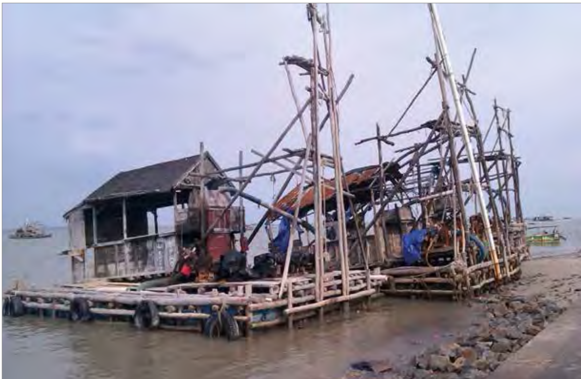
Abbildung 38: An Land gezogene, sonst durch Kleinbergleute im Flachwasserbereich offshore Bangka betriebene Saugbagger. Foto: BGR.
