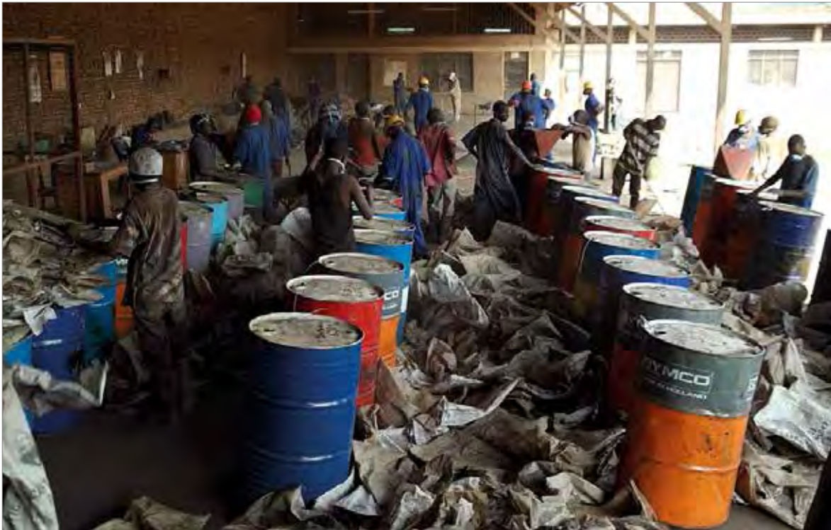
Abbildung 59: Abfüllung von Cassiteritkonzentraten in Fässer für den Export. Foto: BGR.
