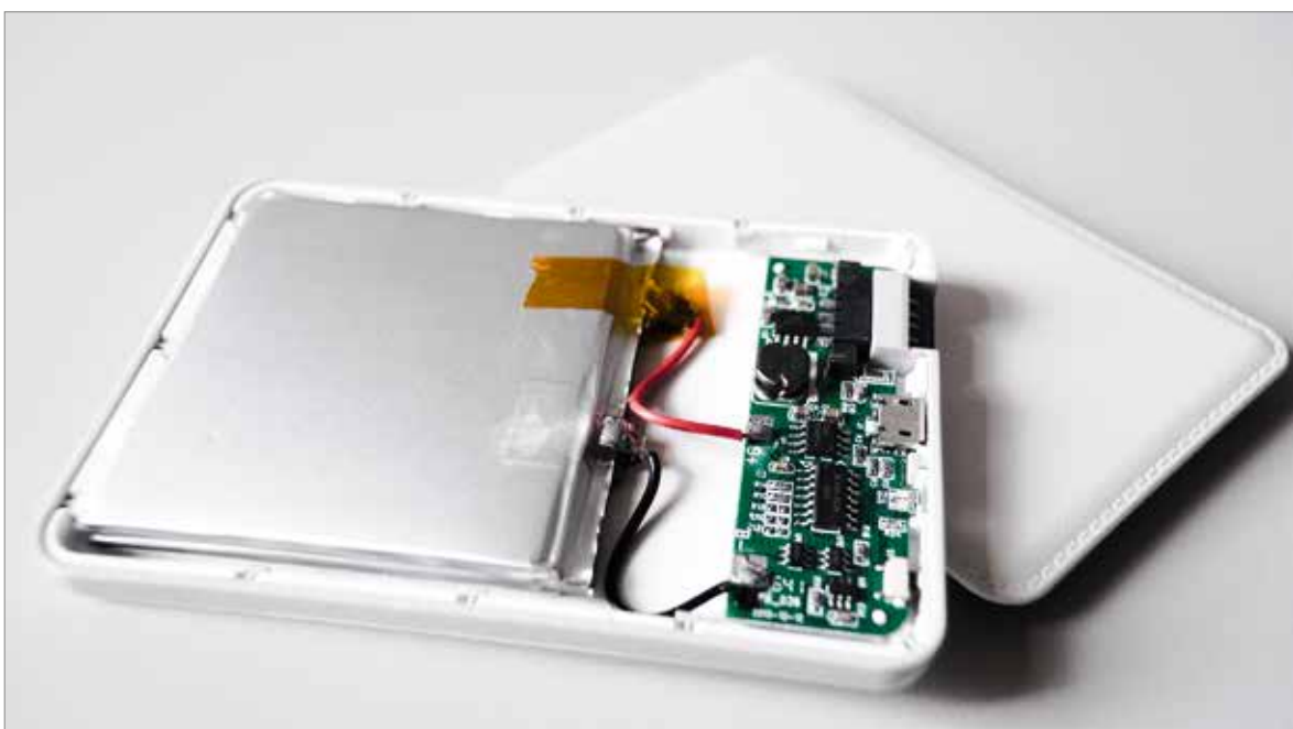
Abb. 12: Pouch-Lithium-Ionen-Zelle mit einer Kapazität von 4.000 mA (BGR 2017).
