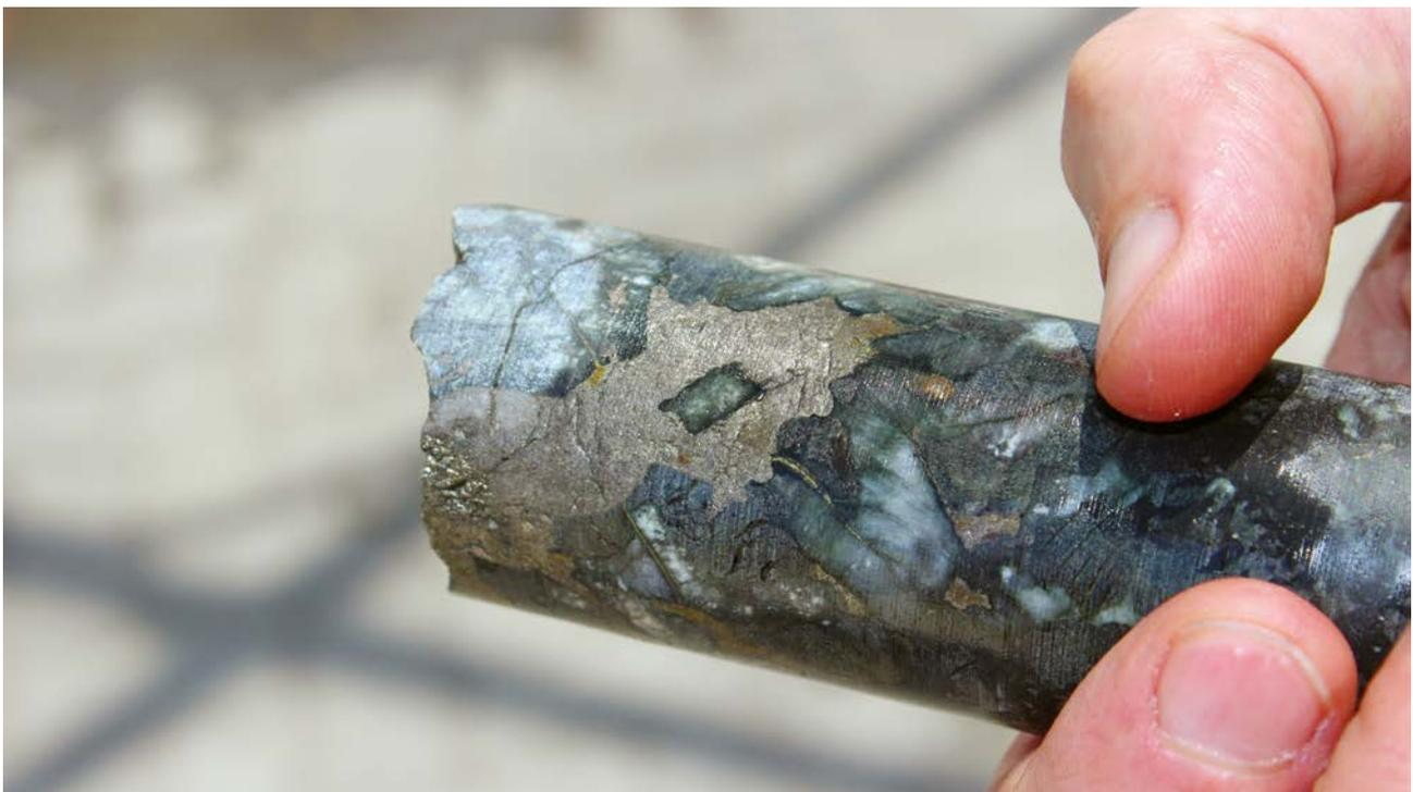
**Abb. 3:** Bohrkern aus dem Platreef, Südafrika, mit einem sehr großen Pentlanditmineral (linker Bereich, bräunliches Mineral), dem Hauptträger von Palladium. Foto: BGR.
