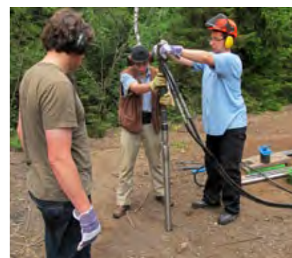
Probennahme auf einer Pochsandhalde mittels Rammkernsondierung.
