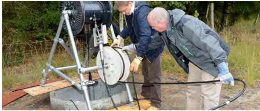
Installation des Seismometers einer Erdbeben-Messstation im niedersächsischen Rethem (großes und kleines Bild)
