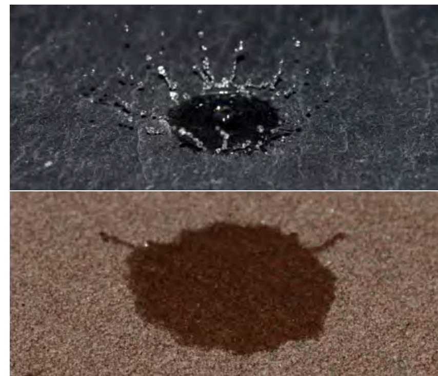
Für eine nachhaltige Speicherung von CO 2 im Untergrund sind gute Speichergesteine (unten) und insbesondere langfristig wirksame Barrieregesteine (oben) erforderlich.
