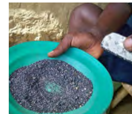
Trennung von Zinnerz mit Magneten in Lulingu, Provinz Süd Kivu.
