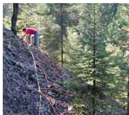
Installation der Elektroden für die geophysikalische Vermessung einer Pochsand-/Bergehalde im Westharz.
