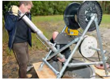
Installation des Seismometers einer Erdbeben-Messstation im niedersächsischen Rethem (großes und kleines Bild)
