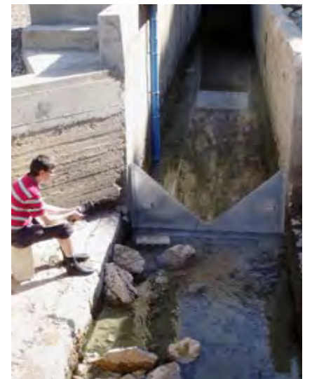
Abflussmessung an der Karstquelle Naber al Labane im Libanon.
