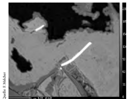
Rückstreuungsaufnahme eines oxidierten Platinerzes vom Platreef in Südafrika. Die hellen Phasen sind Platinoxide in einer Matrix aus Eisenhydroxiden (mittelgrau) und eisenreichen Silikaten (dunkelgrau).
