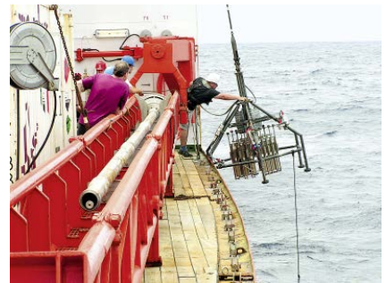
▲ Der Kastengreifer wird zum Einsatz am Meeresboden von Bord gelassen.
