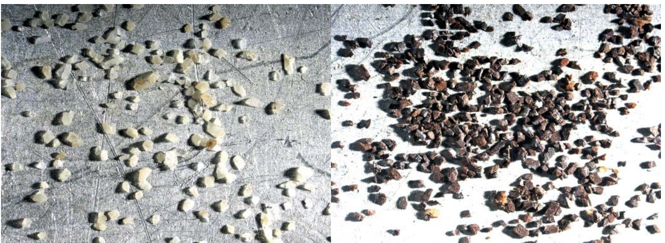
▲ Siderit- und Ankeritkörner (Größe: 100 – 200 µm) verändern sich unter dem Einfluss von CO 2 und Sauerstoff (links: Ausgangsmaterial, rechts: Reaktionsprodukt).
