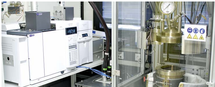
▲ An einen Hochdruckreaktor (rechts) direkt gekoppeltes gaschromatographisches Analysensystem (links) zur Untersuchung der Freisetzung von Kohlenwasserstoffen und Bedingungen untertage.
