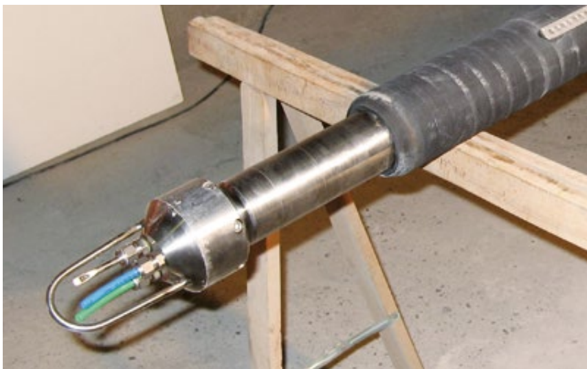
▲ Schlitzpacker für die Bestimmung der hydraulischen Anisotropie, der richtungsabhängigen hydraulischen Eigenschaft des Tongesteins.
