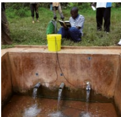
▲ Messungen der Leitfähigkeit des Grundwassers bei einem Markierungsversuch.
