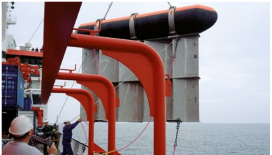
▲ Die Scherbretter spreizen die einzelnen Komponenten einer 3D-Messung während der Fahrt um 150 Meter hinter dem Schiff auseinander.
