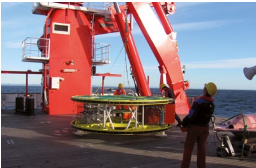
▲ Das elektromagnetische Messsystem Golden Eye wird für künftige Einsätze in den deutschen Massivsulfid-lizenzgebieten erstmalig getestet.
