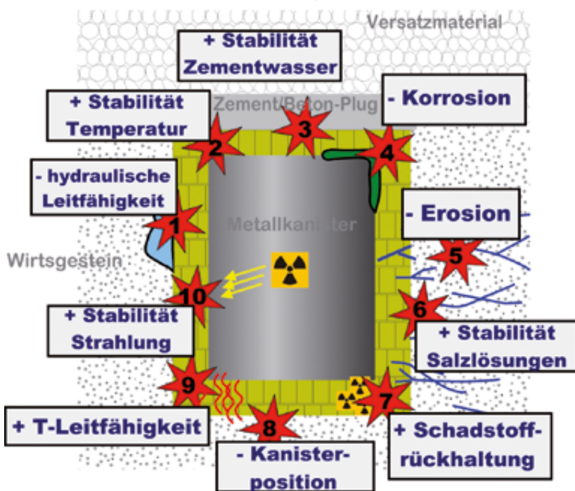
▲ Schematische Darstellung einer Multikomponentenbarriere und zehn wesentliche Faktoren für die Wahl des richtigen Bentonits.
