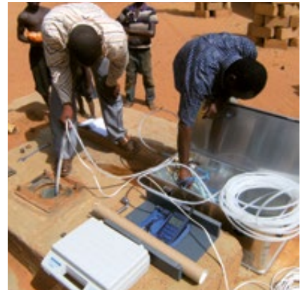
▲ Grundwassermessungen an einem Überwachungsbrunnen in Niamey.
