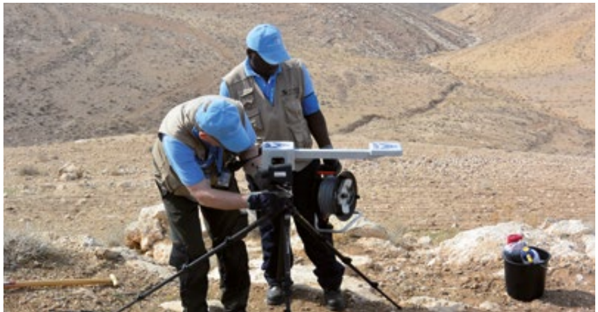
▲ Die genaue Bestimmung der Position der seismologischen Stationen, wie sie hier von zwei Inspektoren ermittelt wird, ist die Grundvoraussetzung für die anschließende Auswertung der erfassten Bodenbewegungen, in denen sich Hinweise auf mögliche Nachbeben verbergen können.
