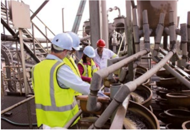
▲ Aufbereitung von Chromit und Platingruppenmetallen aus Haldenmaterial.
