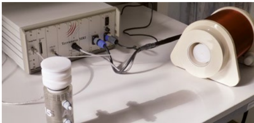
▲ Miniaturausgabe eines Magnetspintomographen für Messungen der Nuklearmagnetischen Resonanz von Sediment- und Bodenproben.
