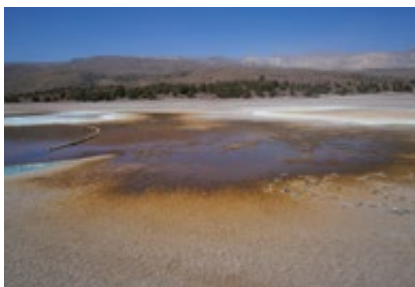
▲ Ausfällungen von Mobilisaten auf der Haldenoberfläche: Eisenhydroxide (rötlich) und Kupfersulfate (blau, weiß).
