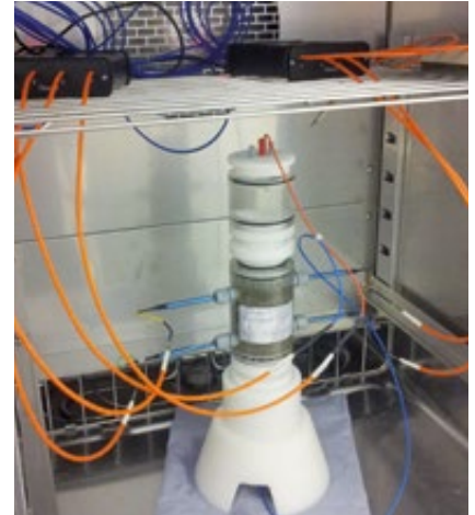
▲ Messung der elektrischen Impedanz einer Sedimentprobe im Klimaschrank.
