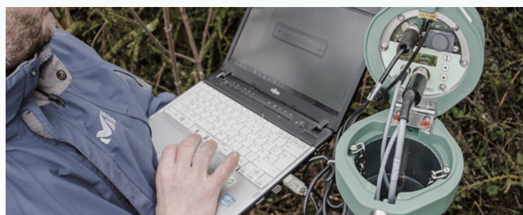
Auslesen der Daten einer Grundwassermessstelle.
