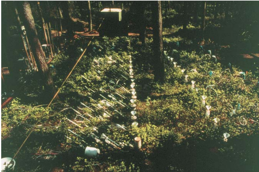
Messstelle in einem Kiefernwald zur Erfassung der Wasser- und Stoffflüsse in Sandböden unter Wald.
