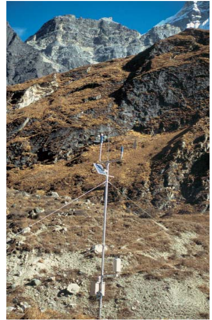
Automatische hydro/meteorologische Station am Thulagi-Gletschersee in 4000 m Höhe zur Überwachung der Abfluss- und Wetterdaten.
