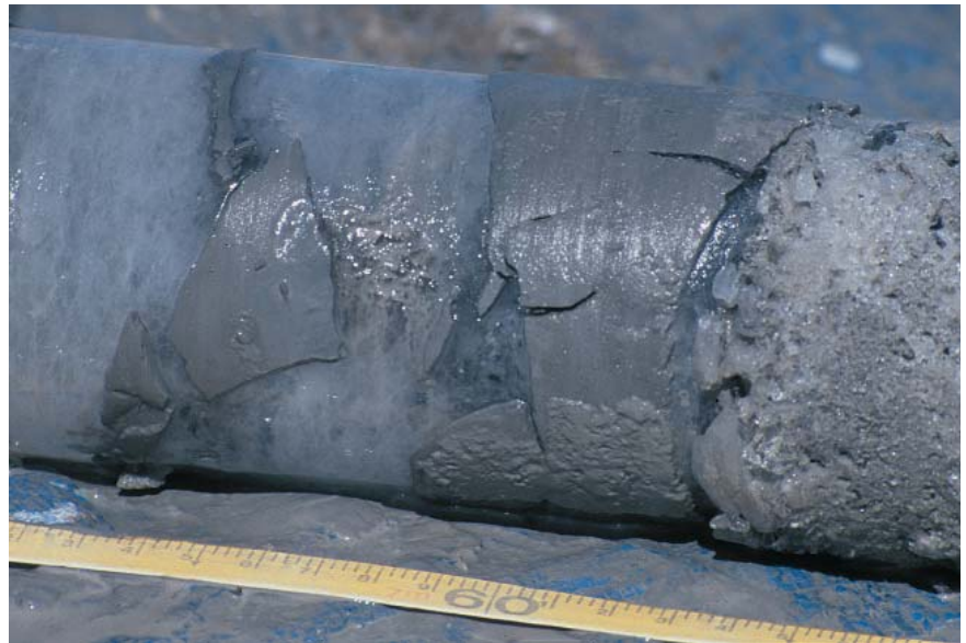
Bohrkern aus einer Eisaufwölbung. Mariner Ton ist weitgehend durch massive Eisbildung zerrissen worden.
