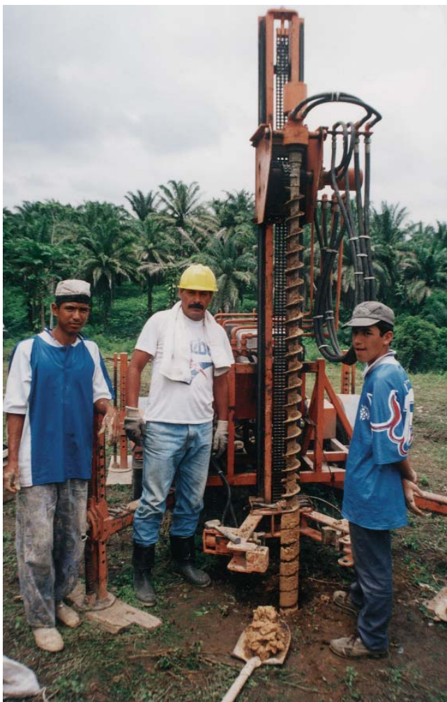
Schneckenbohrsondierung in allophanhaltigem Lehm, Provinz Pichincha, Ecuador.
