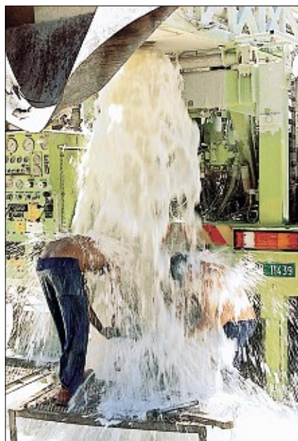
Unter gewaltigem artesischen Druck schießen mehr als 200 m 3 /h Wasser aus einem Bohrloch über dem „Oshivelo Artesian Aquifer“ hervor.
