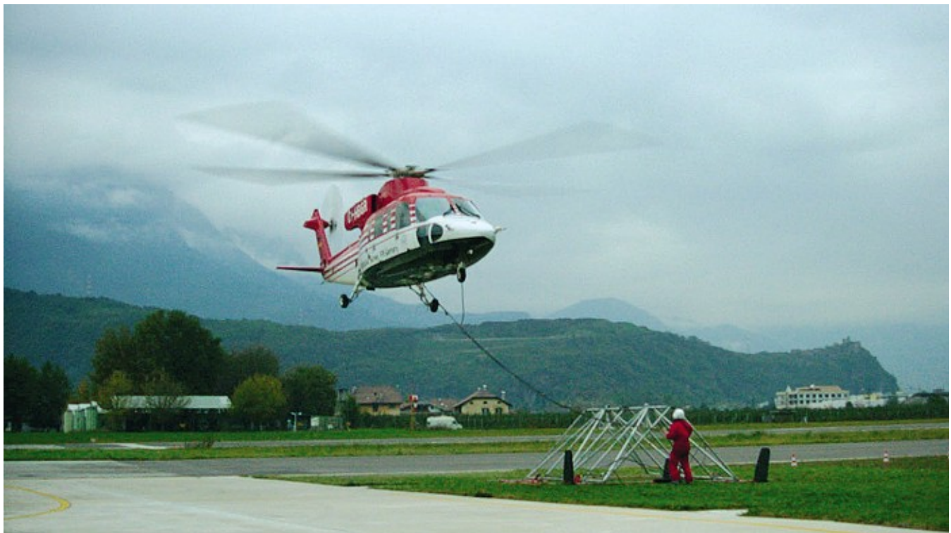
Hubschrauber mit dem Antennensystem des Georadars der BGR.
