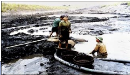
Unfallträchtige und gesundheitsschädliche Deponierung von Schlammkohle aus einer Steinkohletagebauentwässerung.
