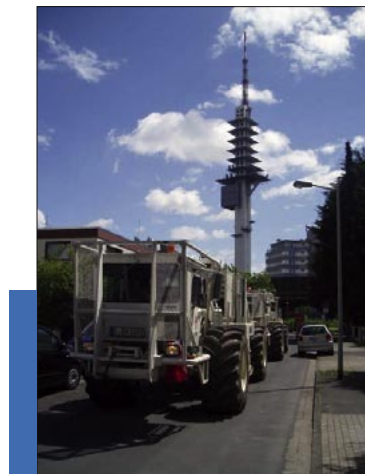
Arbeiten zur Erstellung eines seismischen Profils mit Vibratoren der Firma DMT Essen.
