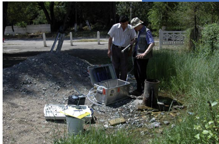
Wasseranalyse am Fuße einer Abraumhalde in der Nähe von Mailuu-Suu mit mobilem Equipment.
