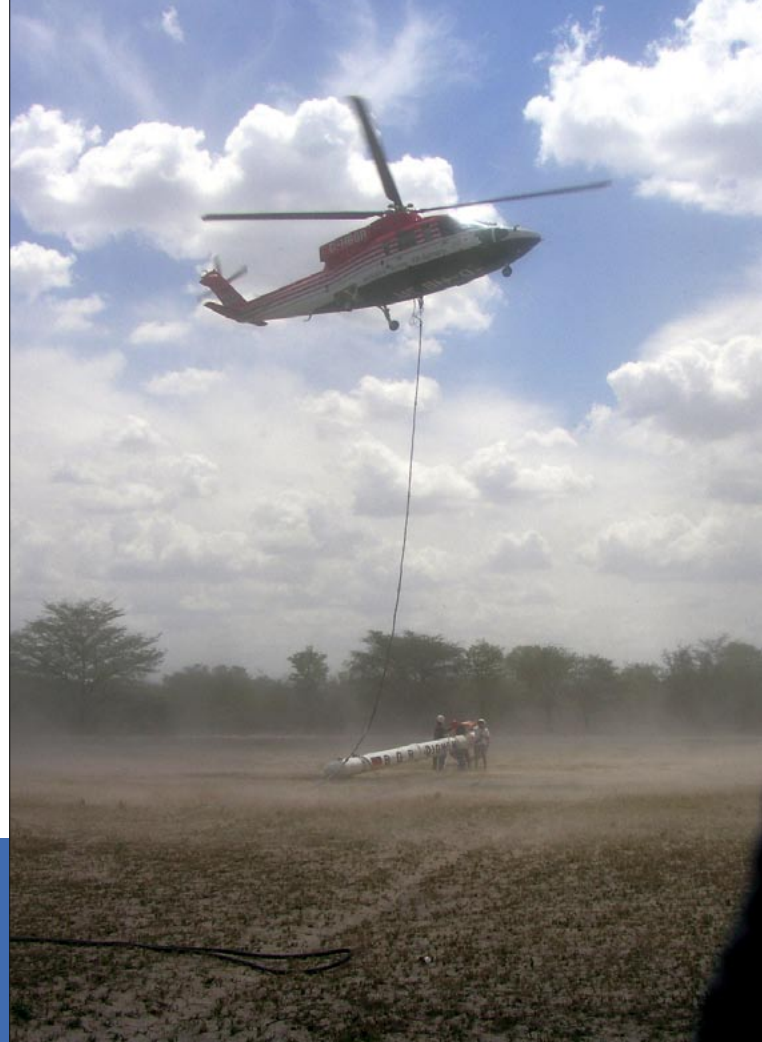
Grundwassererkundungen mit dem Hubschrauber D-HBGR im Nordosten Namibias.
