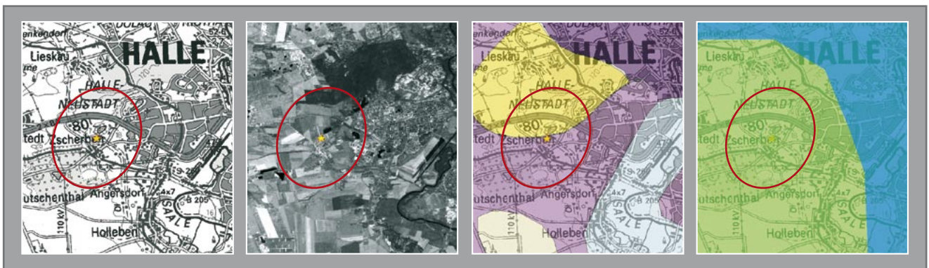
Die Lage des von ALISE berechneten Epizentrums eines Erdbebens (Stern) wird zusammen mit der Fehlerellipse (rot) auf verschiedenen Karten dargestellt. Von links nach rechts: Topographische Karte 1 : 25000 (verkleinert), Satellitenbild (25 m Auflösung), Geologische Karte 1 : 200000 (verkleinert) und kann mit zusätzlichen Informationen, wie z. B. dem Bereich potenzieller Schäden (ganz rechts), überlagert werden.
