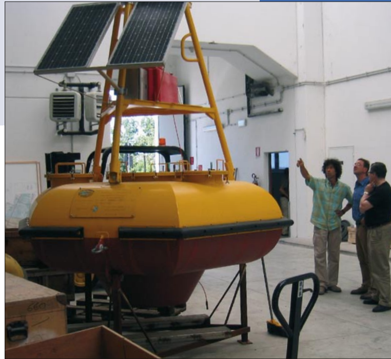
Monitoring-Bojen für den Einsatz im Meeresbereich zur Registrierung von möglichen CO 2 -Austritten.
