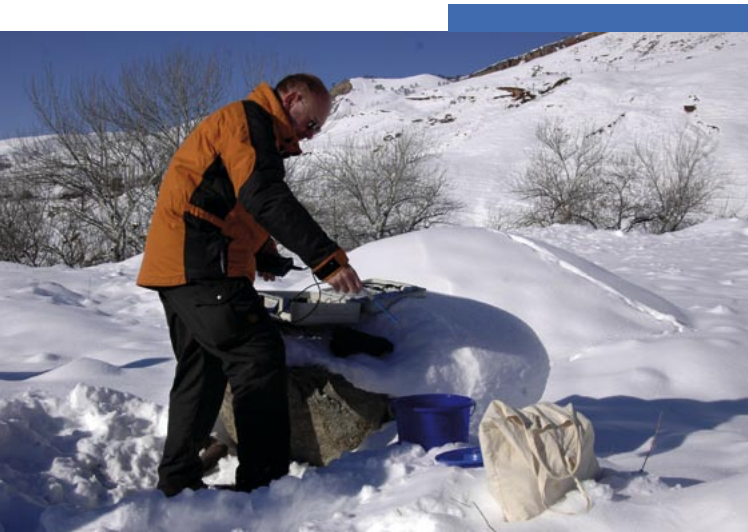
Wasseranalyse an einem artesischen Brunnen in Mailuu-Suu mit mobilem Equipment.
