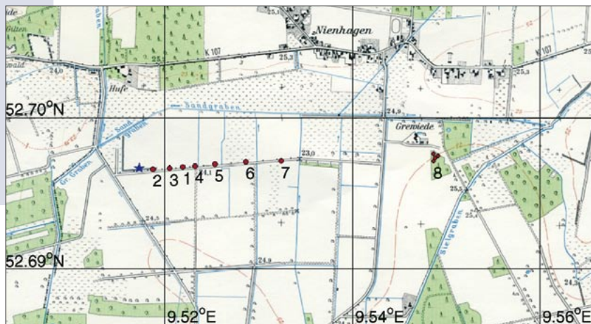
Infraschallmessung an der 200 kW Windkraftanlage vom Typ Vestas V47 nördlich von Hannover (blauer Stern). Die Registrierung mit MB2000 Mikrobarometern erfolgte entlang eines etwa 2 km langen Profils (rote Punkte).
