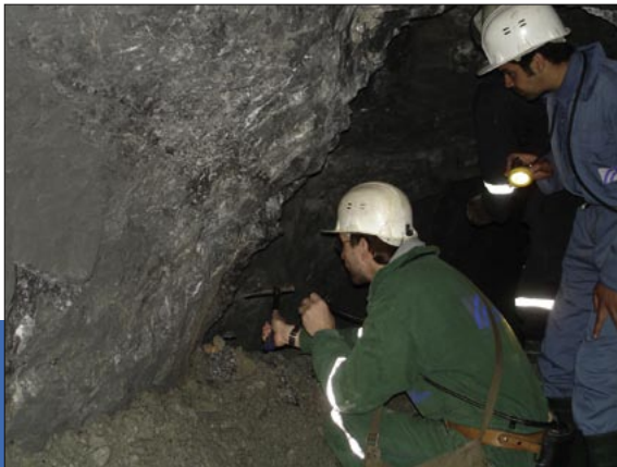
Probennahme von Kobalt-Arsen-Erz in Diorit in der Bou-Azzer-Mine.
