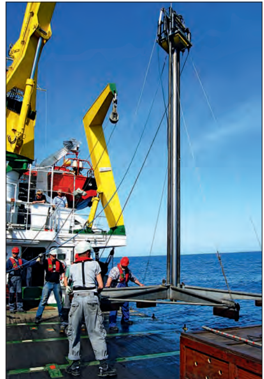
Einsatz des ‚Vibro-Corers‘ zur Gewinnung von bis zu 6 m langen Kernen aus dem Meeresboden.
