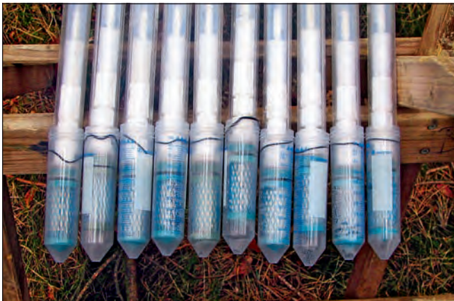
Bereit zum Einbau: die Spitzen der Sickerwassersaugsonden.
