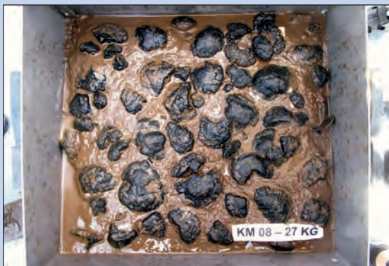
Aufsicht auf einen frisch geborgenen Kastengreifer. Der Kastengreifer sticht ein kleines Stückchen Meeresboden mit der Kantenlänge von 50 cm inklusive der aufliegenden Manganknollen aus und bringt sie an Bord des Schiffes. Die Knollen sind hier etwa 5-10 cm gross und oft zerbrochen (unregelmässiger Umriss).
