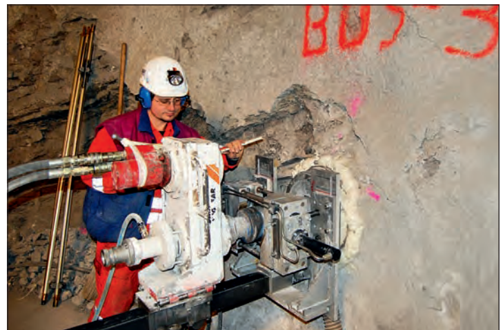
Spannungsmessungen im Felslabor in Mont Terri.
