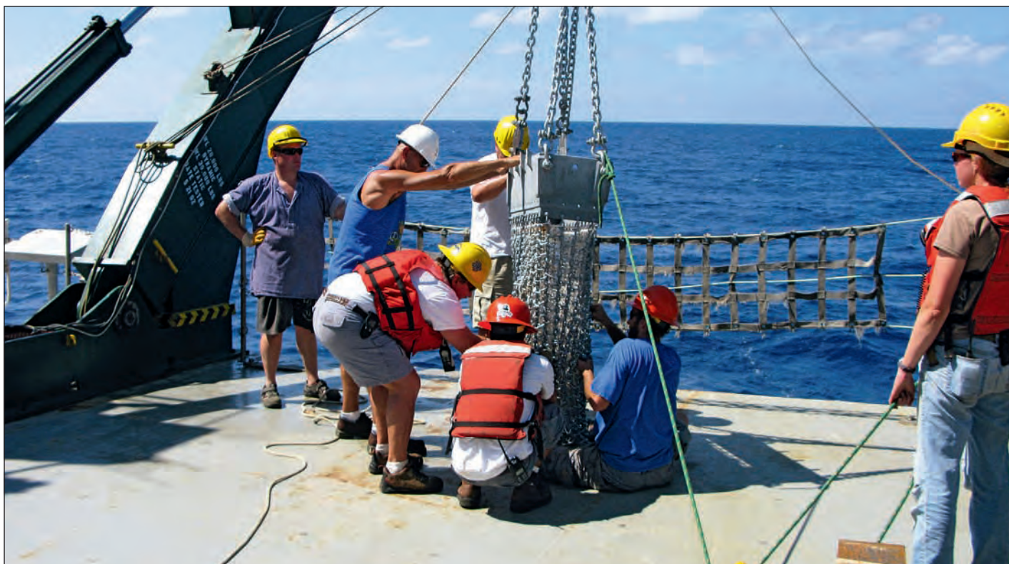
Vorbereitung des Einsatzes einer Kettensackdredge an Bord des Forschungsschiffes 'Kilo Moana' zur Gewinnung einer Manganknollenprobe in 4800 Meter Wassertiefe aus dem deutschen Lizenzgebiet.
