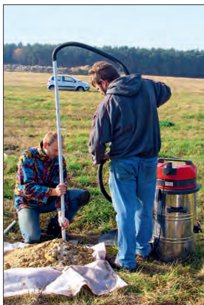
Vorbereitung des Bohrloches zur Entnahme von Bodensickerwasser.
