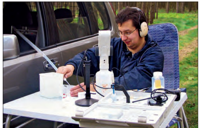
Aufbereitung der Bodensickerwasserproben im Gelände.
