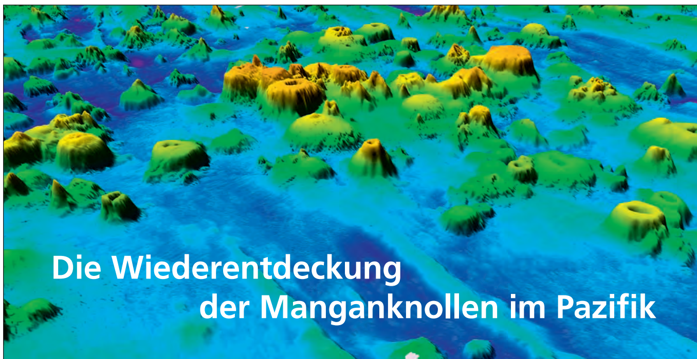
3D-Ansicht eines kleinen Teilgebiets des deutschen Manganknollen-Lizenzgebiets mit zahlreichen submarinen Vulkanen. Das Teilgebiet im Zentrum mit vielen Vulkankegeln ist für eine Manganknollenförderung wenig geeignet, die etwas dunkler blaugefärbten Randzonen dagegen schon.
