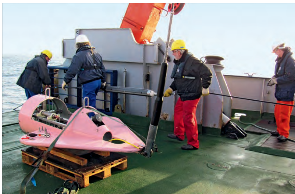
Aussetzen des CSEM-Systems auf der ‚RV Poseidon‘ im Schwarzen Meer. In den Empfangsdipolen befinden sich Druckzylinder mit der Analogelektronik und den Datenloggern zum Aufzeichnen der Signale.
