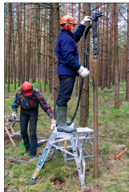
Entnahme von Bodenproben aus der ungesättigten Bodenzone bis zum Grundwasser.
