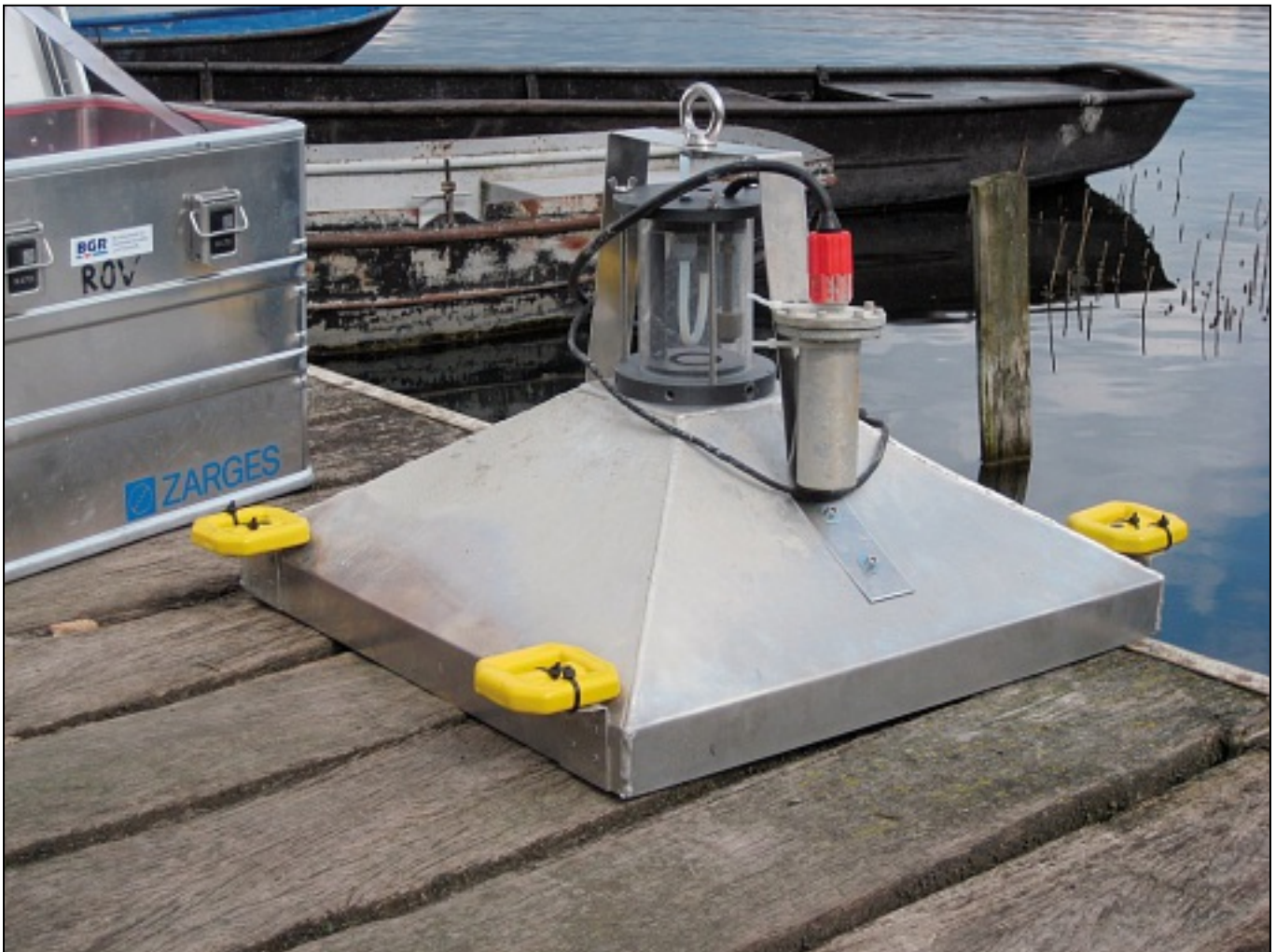
Stationäres Messsystem zur Langzeitüberwachung.
