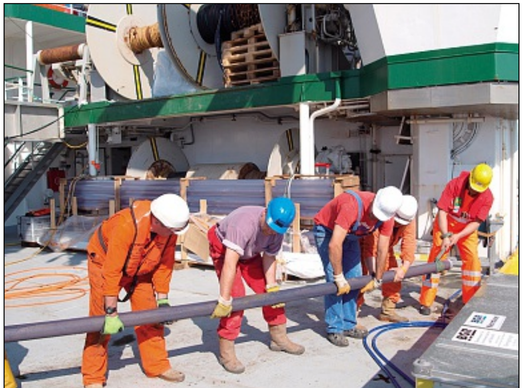
Transport des Bohrkerns zur weiteren Verarbeitung an Deck.
