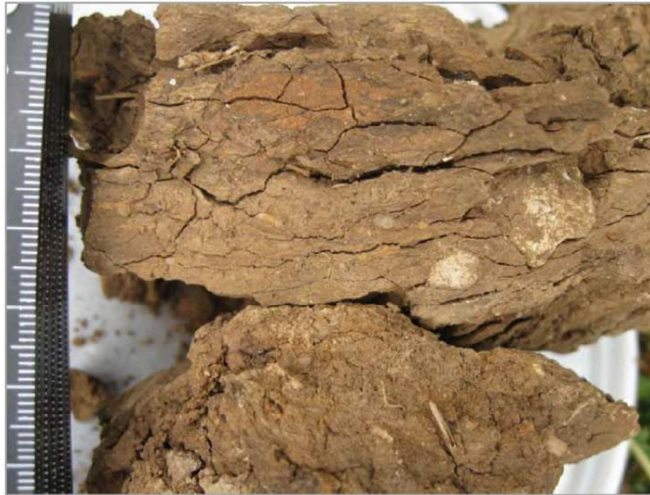
Abb. 13: Plattengefüge als Indikator schwerer Strukturschäden durch Bodenverdichtung (Foto: Jörg Zausig, GeoTeam GmbH 2014).
