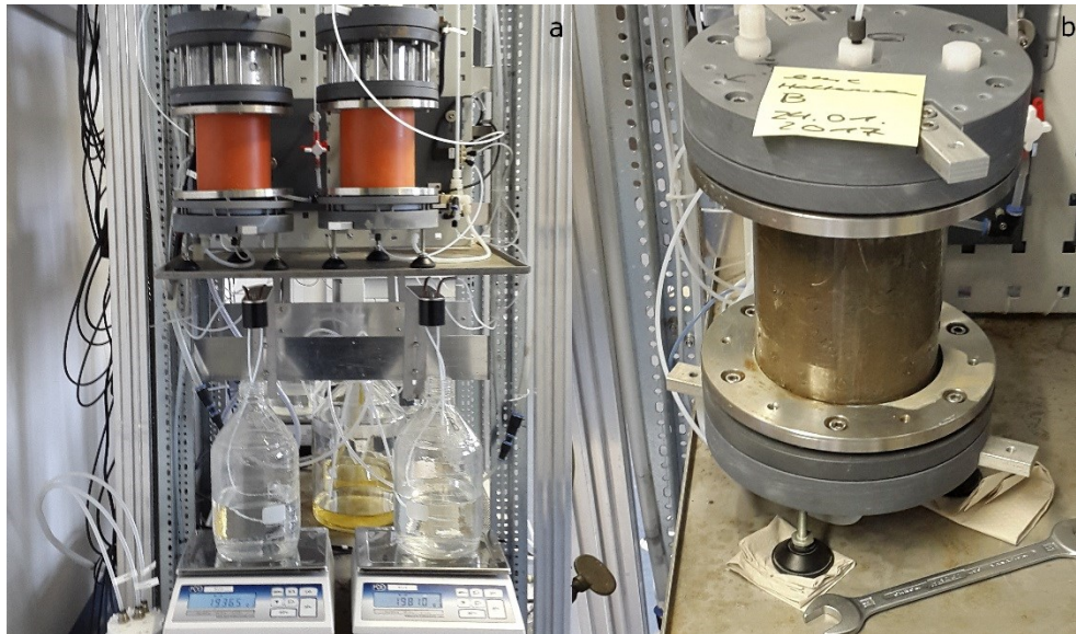
Abbildung 6: Automatische Säulenanlage ausgestattet mit Beregnungsköpfen und Bodensäulen, unterhalb sind die wägbaren Vorratsgefäße sichtbar (a). Mit diesem Versuchsdesign werden ungesättigte Versuche gefahren. Plexiglassäule mit Luvisol gestochen am Standort Holtensen (b). Mit diesem Versuchsdesign werden gesättigte Versuche gefahren. Um mögliche Randflüsse zu visualisieren, werden teilweise Säulen aus Plexiglas eingesetzt.
