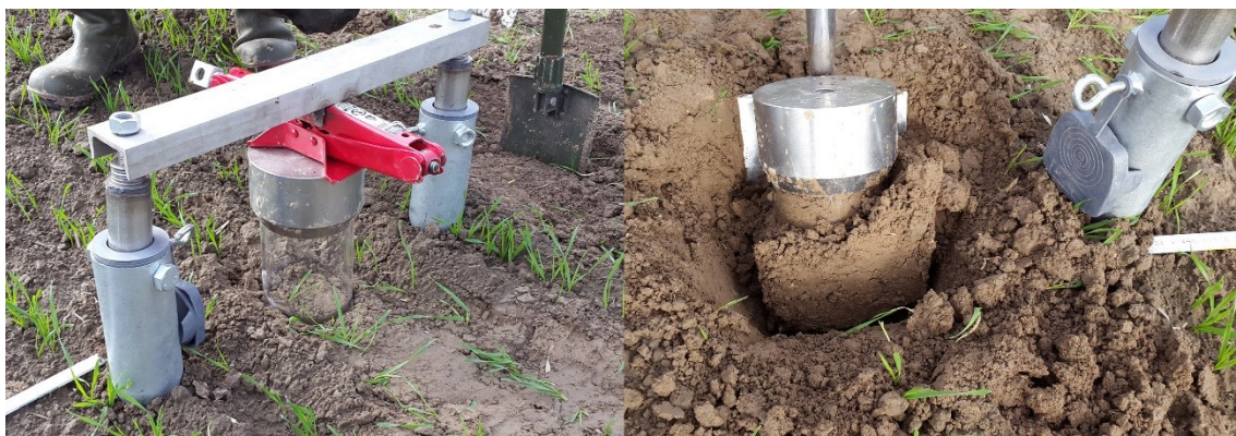
Abbildung 5: Probenahmetechnik zum Stechen und Entnehmen von Bodensäulen im Gelände.
