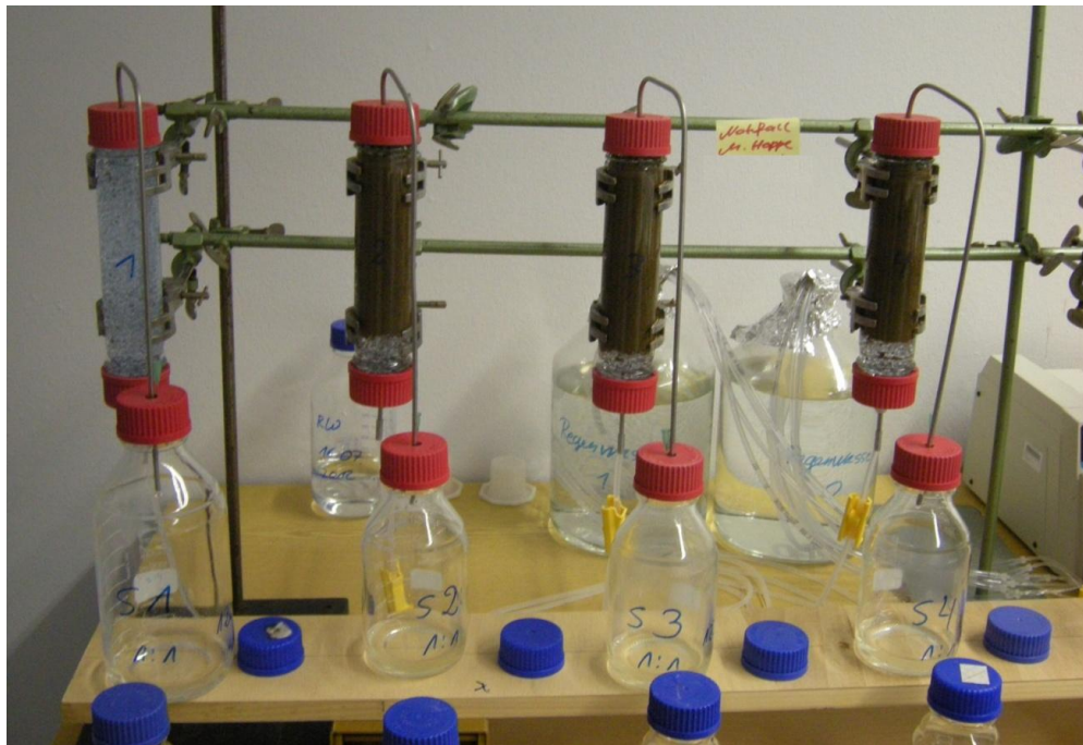
Abbildung 26: Versuchsaufbau bei der Elution von Bodensäulen
