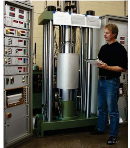
Beheizbare triaxiale Prüfmaschine im gesteinsphysikalischen Labor der BGR
