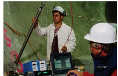
Permeabilitäts-Messungen zur Charakterisierung der Auflockerungszone
