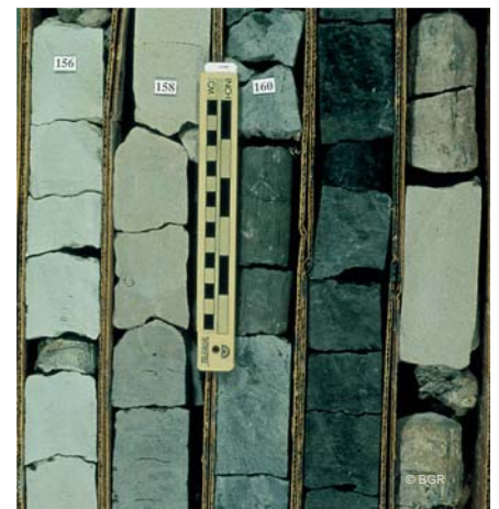
Bohrkerne mit unterschiedlich ausgebildetem Tonstein
