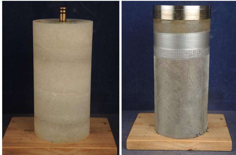
Abb. 2.7: Steinsalz Probe 314/L8 mit eingeklebtem Druckrohr (links) und Stahlplatte zur druckdichten Stickstoffeinleitung.
