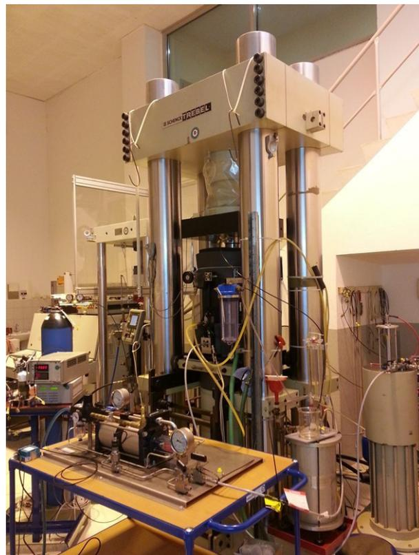
Abb. 2.3: Versuchsaufbau zur Durchführung von Perkolationstests an Steinsalzproben in der Triaxialzelle bei hohen Temperaturen und Drücken (im Vordergrund das Maximator-Drucksystem).
