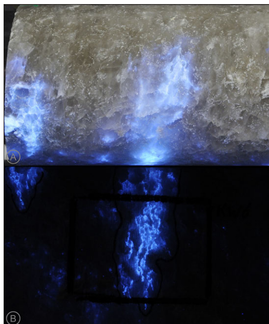
Abb. 12: Beispiel für den in allen Proben beobachteten Halo-Effekt (Probenkörper RB659-012 bei Teufe 1,70 m bis 1,82 m) in einer Kombinationsaufnahme „Kunstlicht und UV-Licht“ (A) bzw. unter UV-Licht bei 254 nm (B; Kernsegment geschnitten). Die an die UV-aktiven Bereiche (i. d. R. Korngrenzen) angrenzenden Halitkristalle werden durch das bei UV-Anregung emittierte Fluoreszenzlicht blau beleuchtet.
