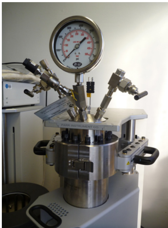
Abb. 103: Hochdruckreaktor für Aufheizversuche an Hauptsalz-Prüfkörpern aus dem Salzstock Gorleben.
