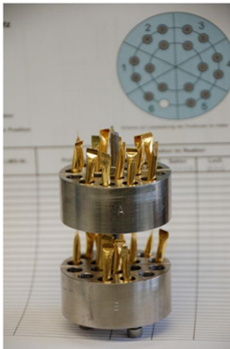
Abb. 105: Halter für Proben für die geplanten Modellreaktionen in verschweißten Goldkapseln.
