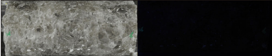
Abb. 4: Als „optisch unauffällig“ eingestufte Probenkörper RB653-008 (Teufe 5,70 m bis 5,86 m) im Kunstlicht (links) und unter UV-Licht ohne sichtbare Fluoreszenz (rechts).
