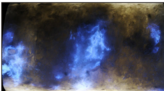
Abb. 11: Kombinationsaufnahme „Durchlicht und UV-Licht“ (Probenkörper RB659-012 bei Teufe 1,70 m bis 1,82 m). Durch die Kombination von UV- und Durchlichtaufnahme werden Halo-Effekte (Abb. 12) reduziert und die Bildinformationen der Durchlichtaufnahme durch die UV-Informationen ergänzt.
