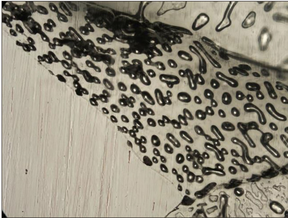
Abb. 24: Interkristalline Fluideinschlüsse auf Halit-Korngrenze (RB757). Die hellen Zentren der blasen- und wurmförmigen Flüssigkeitsphasen sind optische Reflexe. Bei Kontakt einzelner Tropfen können örtlich begrenzt Filme ausgebildet werden (Bildmitte oben). BB = 500 µm. Parallele Nicols im Durchlicht, Photo: N. Thiemeyer.
