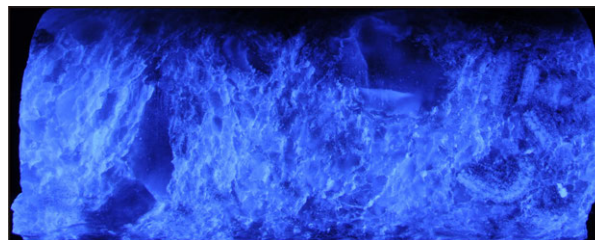
Abb. 8: Als „stark UV-aktiv“ eingestufte Probenkörper RB649-003 (Teufe 0,31 m bis 0,48 m) unter UV-Licht (254 nm). Die Probe weist einen auffälligen „Diesel“-Geruch auf und zeigt bei 254 nm eine ausgeprägte, fahl bläulich-weiße Fluoreszenz entlang der Korngrenzen und der eingeschalteten Anhydritlagen.
