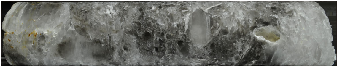
Abb. 5: Als „optisch auffällig“ eingestufte Probenkörper RB648-022 (Teufe 3,00 m bis 3,33 m) im Kunstlicht. Im Liegenden der Probe (rechts) ist eine ca. 1 cm x 2 cm x 1 cm große und mit gelblichem Salzstaub belegte Pore zu erkennen.
