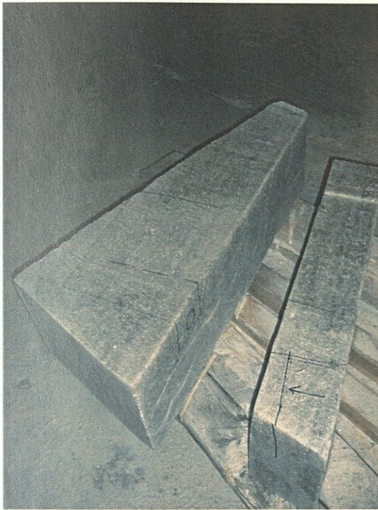
Abb. 2-3. Herstellung der Rohprüfkörper bzw. Probenwürfel. (li.) auf der Seite liegendes Teilsegment des Großblocks mit steilstehender Schichtung. (re.) manuelle Zerlegung des Teilsegments in Rohprüfkörper.
