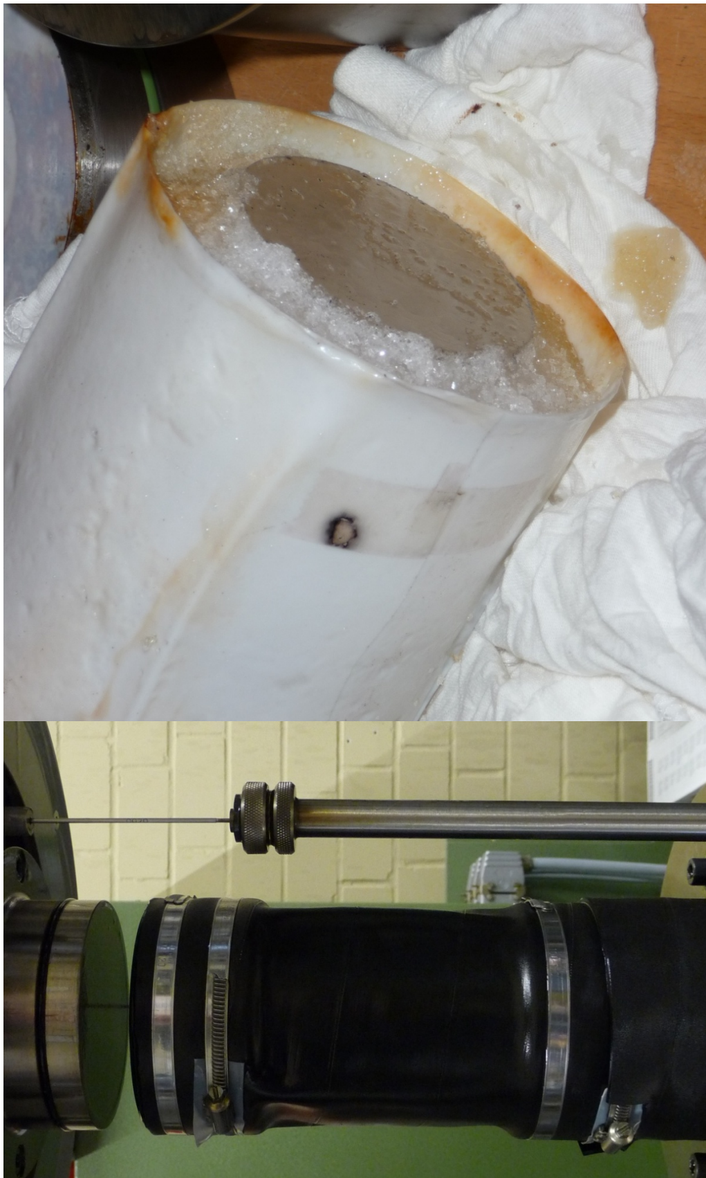
Abb. 9.2: Triaxial-Kriechversuch an Steinsalz (Asse2/94/08036, zZSP): Offene Druckzelle mit Prüfkörper im Schutzschlauch und nach Entfernen der Ummantelung für den mit Mg 2+ -reicher Lösung getränkten Voll-Versatz.
