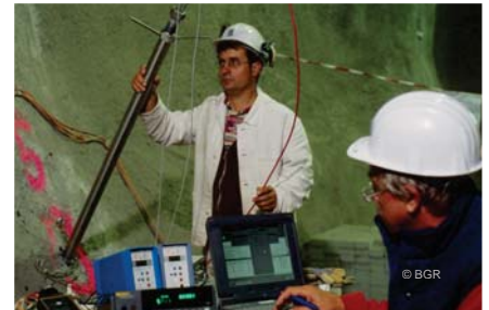
Permeabilitäts-Messungen zur Charakterisierung der Auflockerungszone
