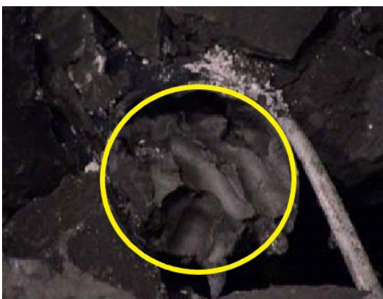
Abb. 10: Selbstabdichtung und vermutete Selbstheilung in Boom-Clay (anorganischer, verfestigter Ton mit im Labor bestimmtem Grenzwert für Plastizität): Mechanische Selbstabdichtung eines ursprünglich offenen Bohrlochliners ( \varnothing \approx 100 mm; gelb markiert) durch plastisch zutretenden Ton, der durch das Rohr gepresst, d. h. extrudiert wird; austretende Lösungen können über chemische Ausfällung eine zusätzliche Abdichtung bewirken (Quelle: Bruns et al. 2011).
