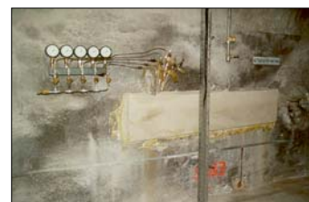
Großdruckkissen zur Ermittlung der In-situ Gebirgsspannungen sowie Darstellung der Messergebnisse (Untertageanlage Neckarzimmern)
