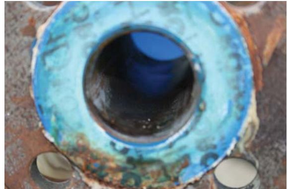
Abbildung 3.73: Vetco blau: gesamter Rohrquerschnitt enthält braun-schwarze Ablagerungen mit silbrig glänzenden Spuren (links Beprobung 19.06.2007, rechts Beprobung 22.11.2007)
