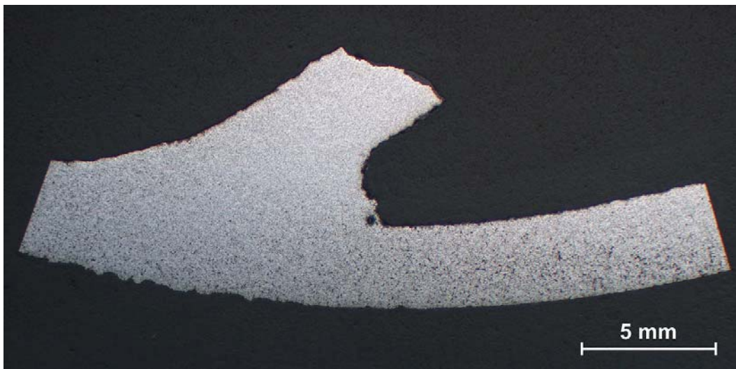
Abbildung 3.37: Pumpe Soutz-sous-Forêts: Übersicht Längsschliff durch Schaufelende Impeller.
