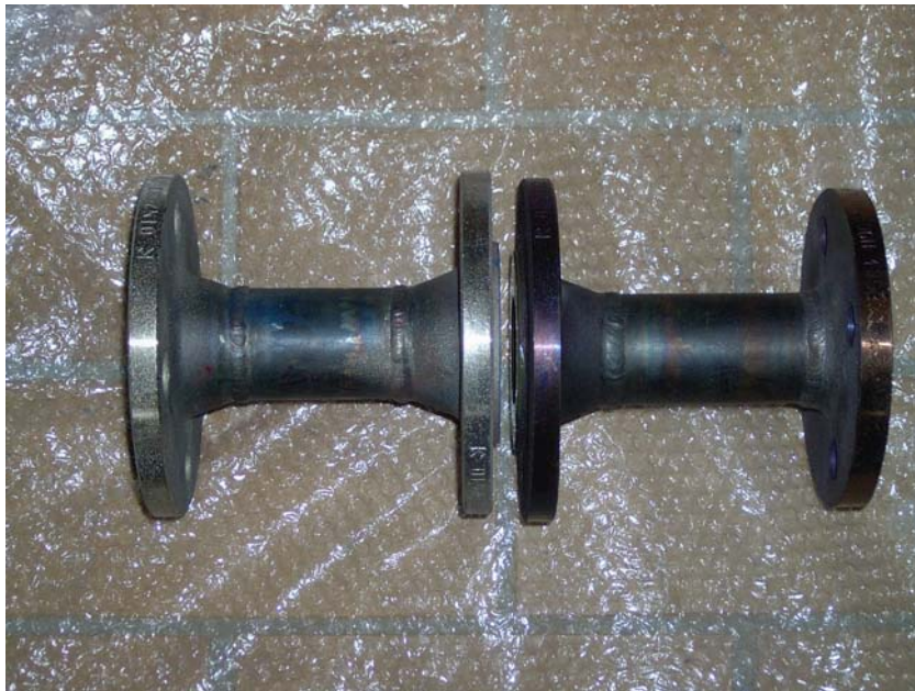
Abbildung 3.63 b: Rohrstücke, beschichtet mit Epoxidharz-Pulver Beschichtungen (links: blaue Beschichtung- RESICOAT® R4; rechts: grüne Beschichtung TK® -236)
