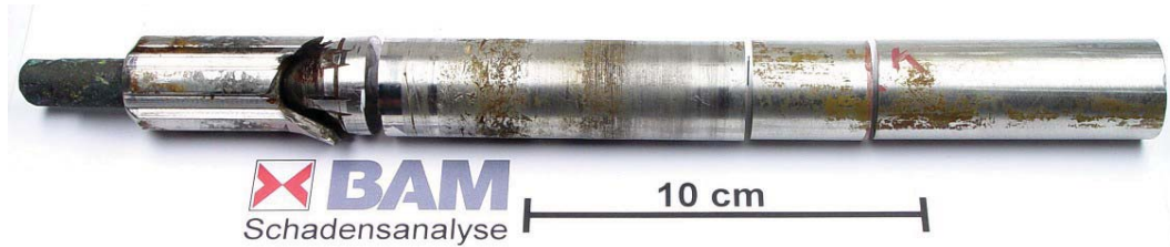
Abbildung 3.16: Pumpe Neustadt-Glewe: Pumpenseitiges Ende der gebrochenen Sealwelle.
