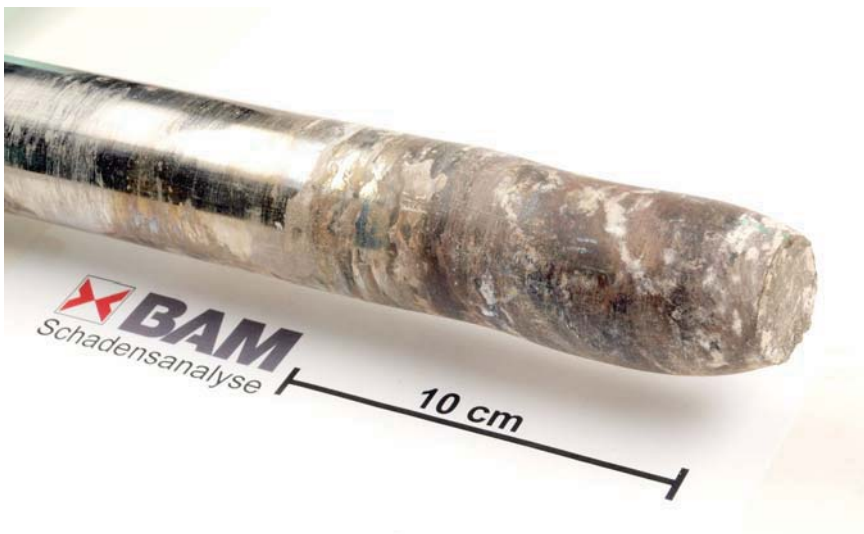
Abbildung 3.31: Pumpe Soultz-sous-Forêts: Bruchstelle der Antriebswelle.
