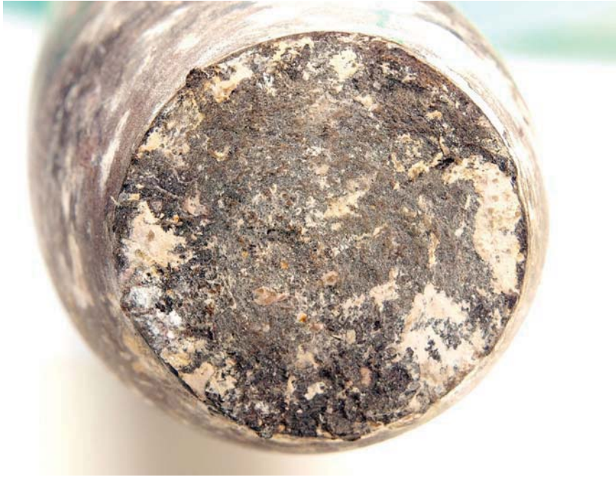
Abbildung 3.32: Pumpe Soultz-sous-Forêts: Bruchfläche der Antriebswelle.
