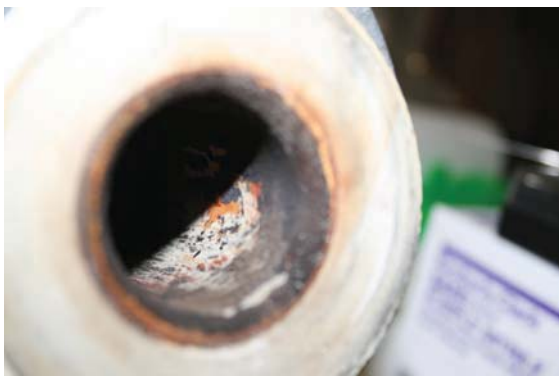
Abbildung 3.74: PP/GFK: Blick in den rechten Rohrabschnitt-Thermalwasseraustritt (rechts: Kratzspuren durch die Probennahme)
