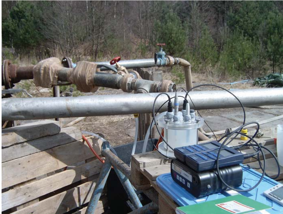
Abbildung 2.1: Messung der Online-Parameter Temperatur, Leitfähigkeit, Redoxpotenzial, gelöster Sauerstoff und pH-Meter während eines Pumptests
