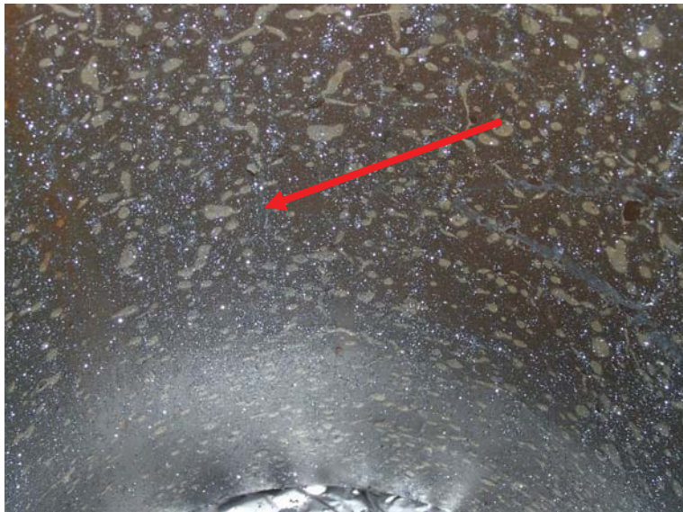
Abbildung 3.58: Blick in das Formstück Nr. 1, roter Pfeil zeigt auf die entfernte hellbraune Schicht
