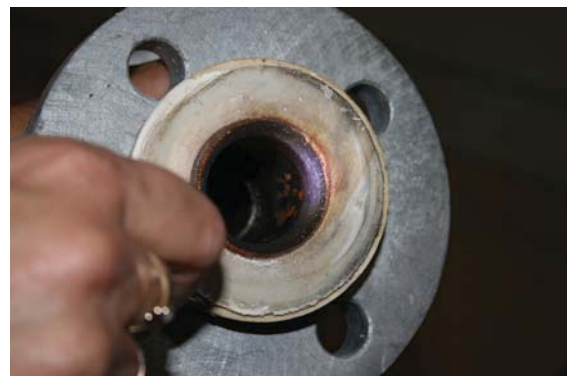
Abbildung 3.74: PP/GFK: Blick in den rechten Rohrabschnitt-Thermalwasseraustritt (rechts: Kratzspuren durch die Probennahme)
