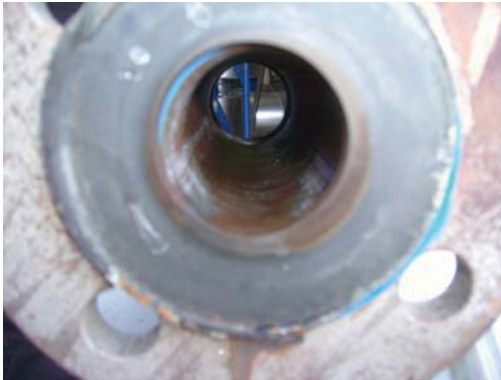
Abbildung 3.73: Vetco blau: gesamter Rohrquerschnitt enthält braun-schwarze Ablagerungen mit silbrig glänzenden Spuren (links Beprobung 19.06.2007, rechts Beprobung 22.11.2007)
