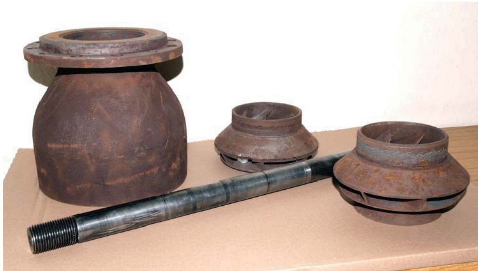
Abbildung 3.28: Pumpe Soultz-sous-Forêts: Prüfstücke der BAM.
