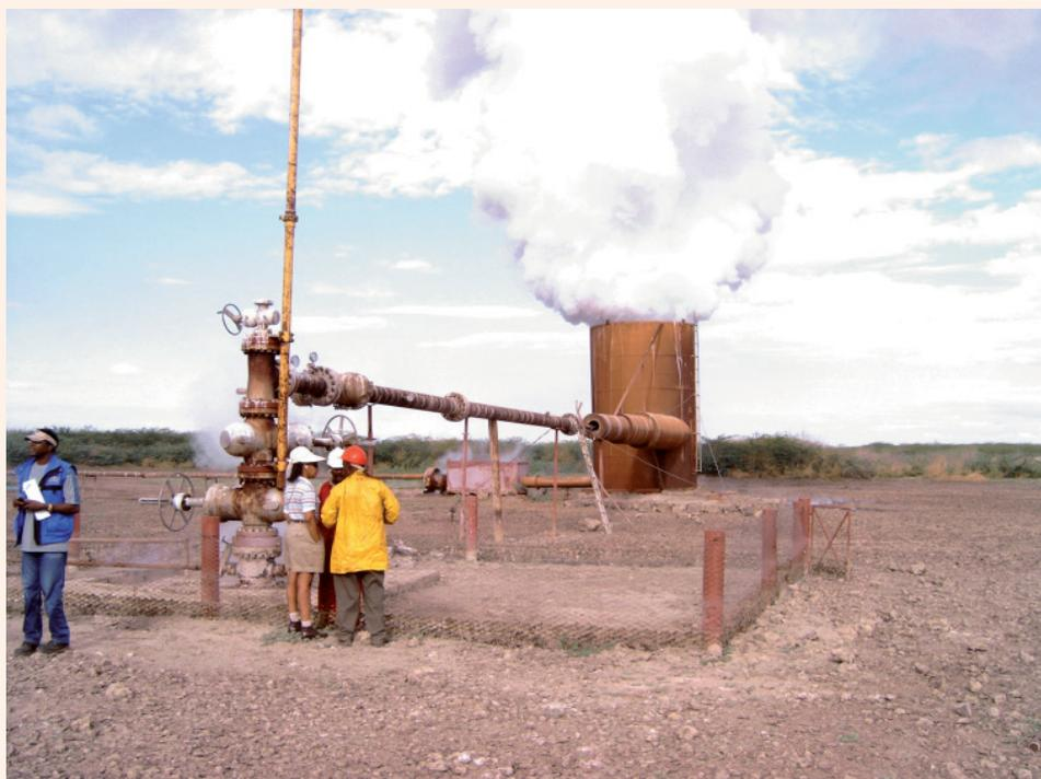
Produktionstest an einer Explorationsbohrung im Geothermiefeld Tendaho, Äthiopien.
