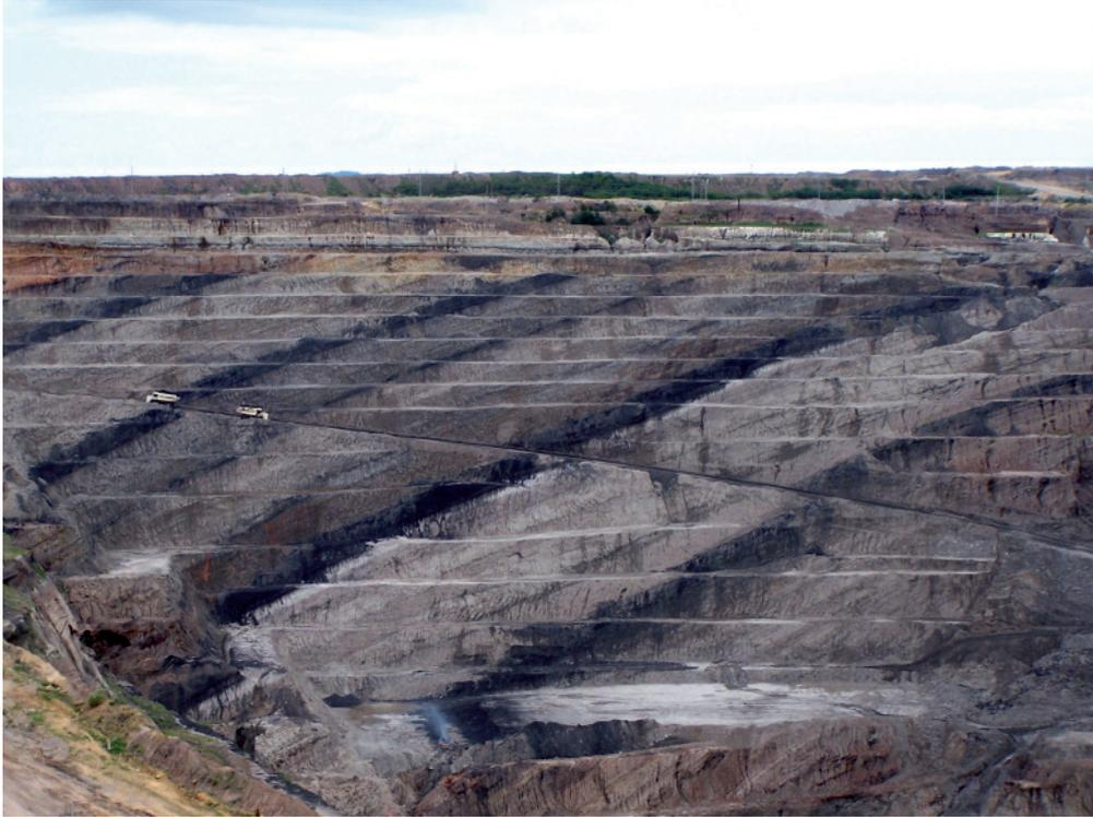
**Abbildung 5.10:** Mehrere Meter mächtige Hartkohleflöze in halbsteiler, schräg einfallender Lagerung im Tagebau Panian auf Semirara Island, dem größten Tagebau der Philippinen.
