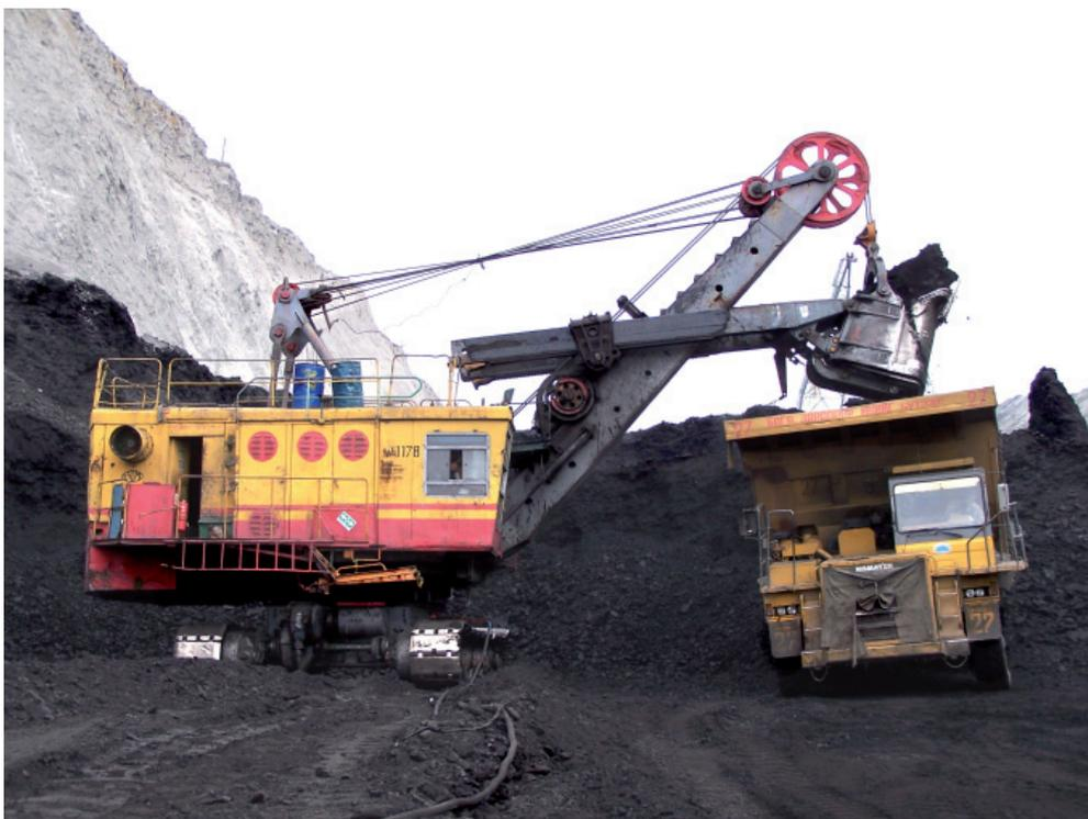
**Abbildung 5.7:** Hartkohleförderung (Rohkohle) per Seilbagger und LKW (Truck and Shovel) im Tagebau Baganuur/Mongolei.
