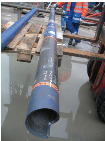
**Abb.3.4:** Fanggarnitur für Fangversuch
