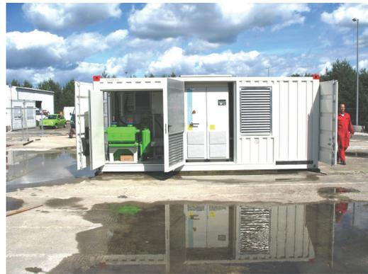
**Abb. 1.5b:** Hochdruckpumpe: Steuerungs- und Pumpenseite mit Frequenzumrichter und Triplexpumpe
