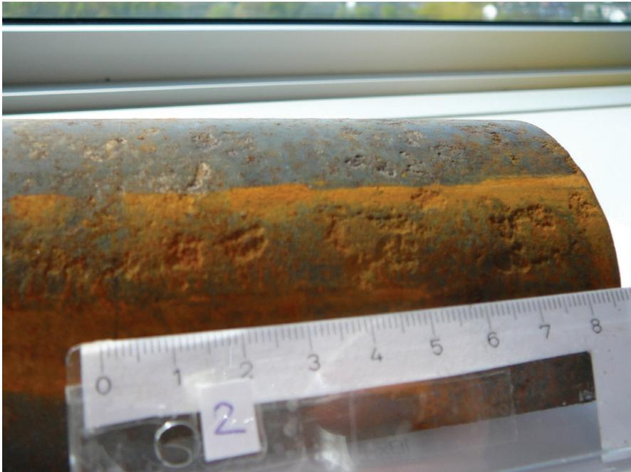
**Abb. 4.2.1:** Korrosionsschäden an der Außenwand von Rohrstück Nr. 2
