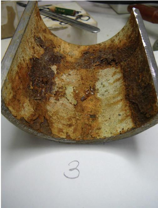
**Abb. 4.2.17:** Bereiche mit größeren Materialablösungen an der Innenwand einer Rohrprobe von unterhalb des Packers
