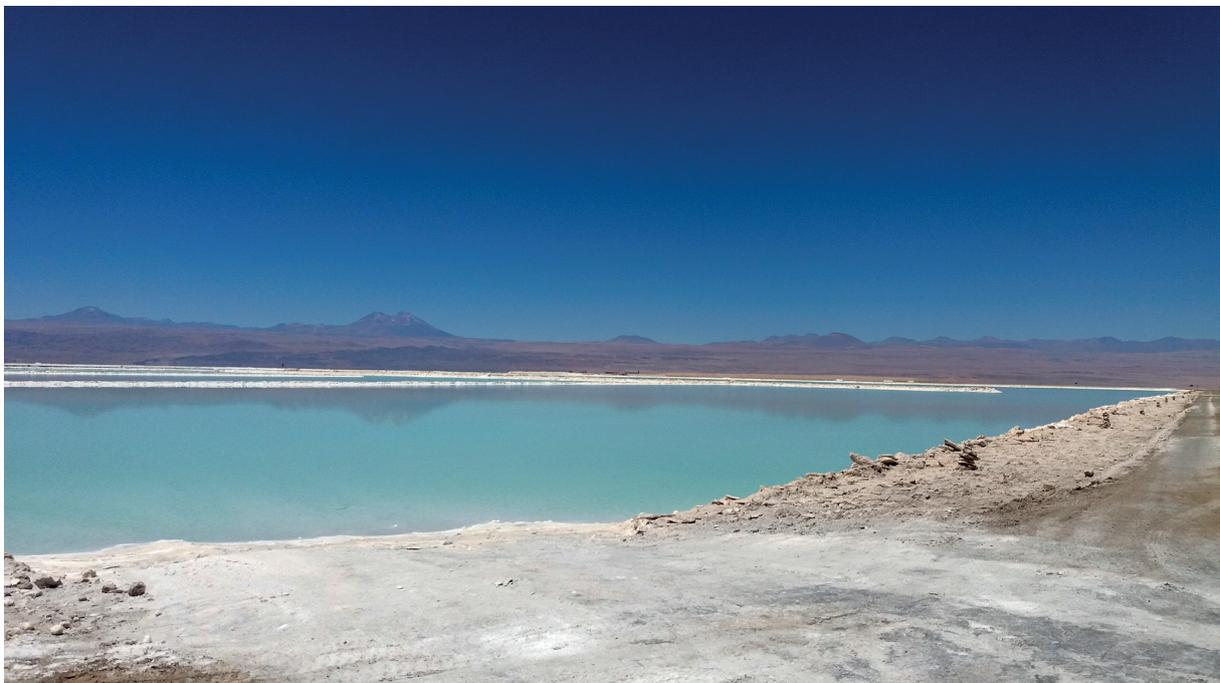
**Abbildung 4-2:** Solarevaporationsbecken der Firma Albemarle (Rockwood Lithium Ltda.) im Salar de Atacama (Chile) (BGR 2016).
