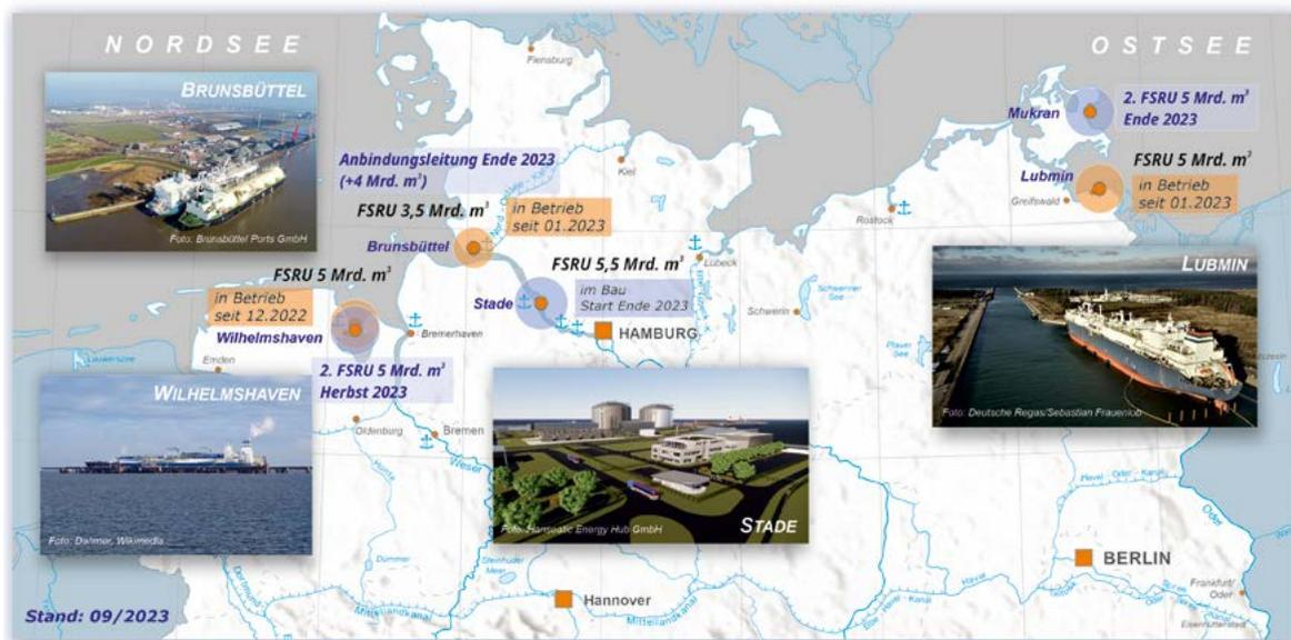
Abbildung 2-2: Bestehende und im Bau befindliche LNG-Importterminals in Deutschland. FSRU (Floating Storage & Regasification Unit – schwimmendes LNG Terminal); Stand: 09/2023.
