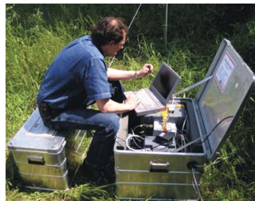
Mobile seismo-akustische Messstation
