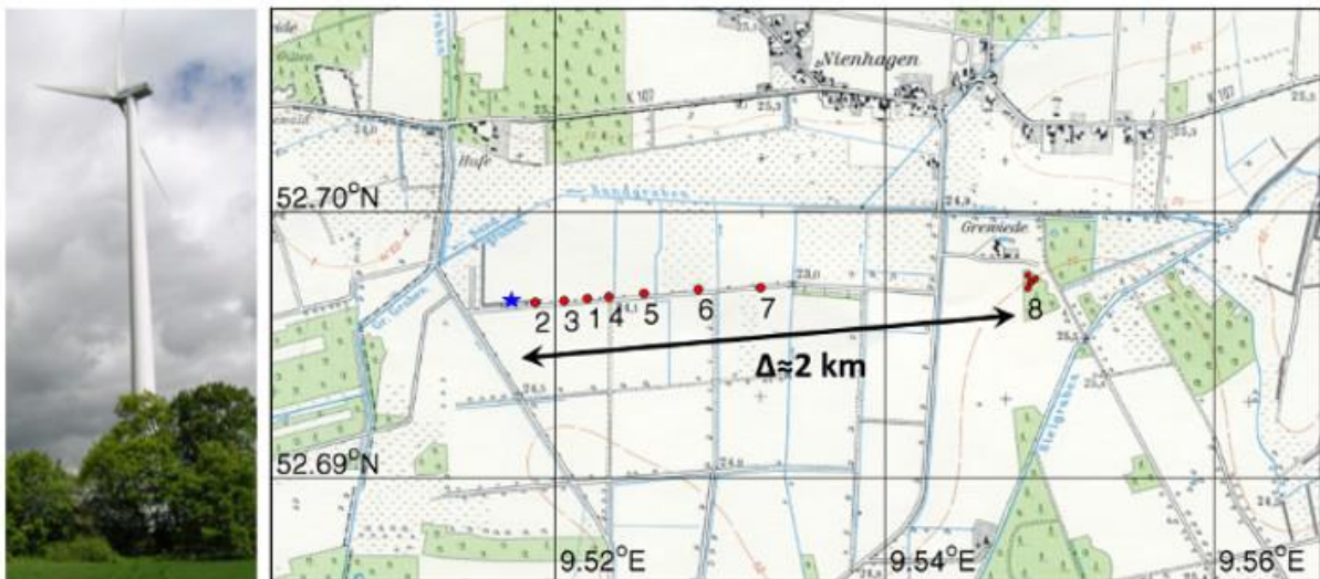
Abbildung 1: Feldmessungen an einer Windenergieanlage vom Typ Vestas V47 nördlich von Hannover. Die Registrierung mit MB2000 Mikrobarometern erfolgte entlang eines etwa 2 km langen Profils.
