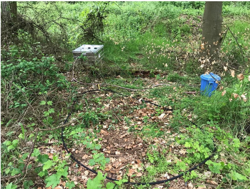
Abbildung 1: Installation einer Infraschall-Mobilstation im für Infraschallmessungen bevorzugten bewaldeten Gelände: Der modulare Aufbau besteht aus dem Mikrobarometer in der blauen Tonne (rechts), der Ausrüstung für Stromversorgung und Datenerfassung in der Aluminiumkiste (links) und dem schwarzen Ring aus porösem Bewässerungsschlauch als Lufteinlass (im Vordergrund).
