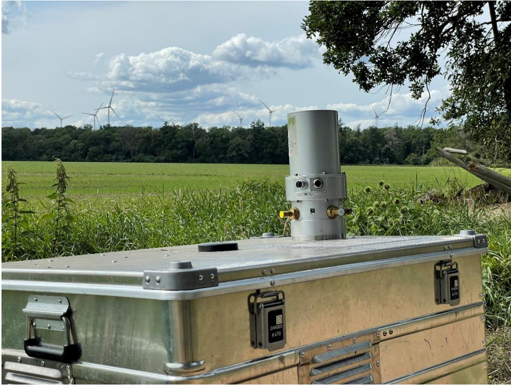
Abbildung 2: Mikrobarometer zur Messung von minimalen Luftdruckänderungen: Über die vier Einlassstutzen (am unteren Teil des Gehäuses) wird nach dem Einbau in die schützende Tonne das räumliche Einlasssystem angeschlossen. Im Hintergrund ist der Windpark zu sehen, dessen Infraschallsignale über mehrere Kilometer Entfernung noch messbar sind.
