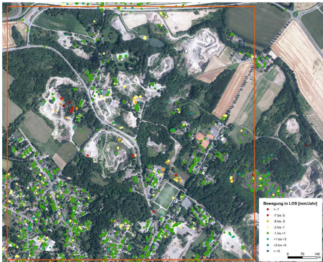
Abbildung 64: PSI-Daten vom Envisat-ASAR-Descending-Datensatz Track 337 über Digitalen Orthophotos DOP40 vom BKG.
