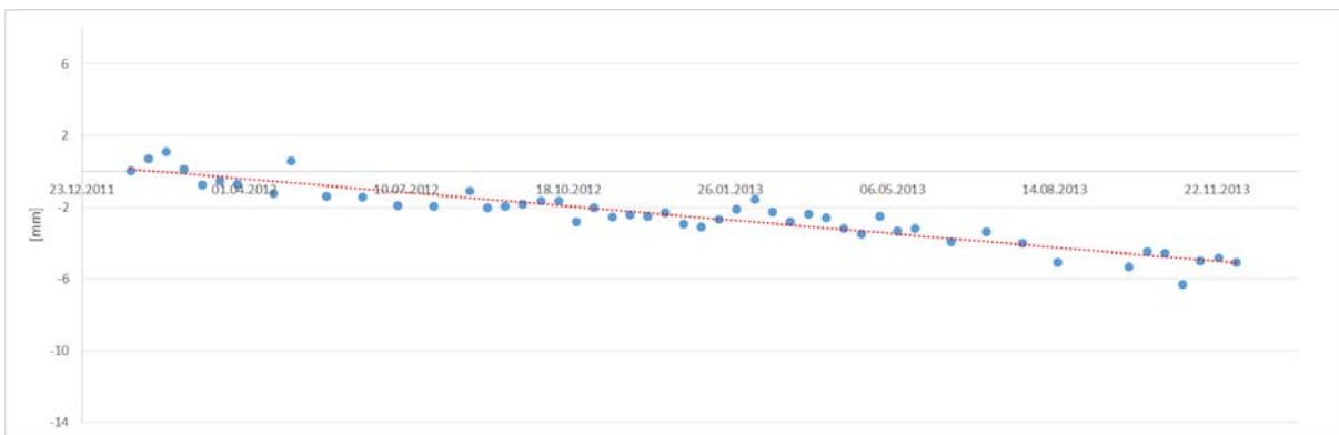
Abbildung 74: Zeitserie des Mittelwerts der SBAS-Daten für Bewegungsgebiet 2 (blaue Punkte) mit linearer Trendlinie (rote Linie).
