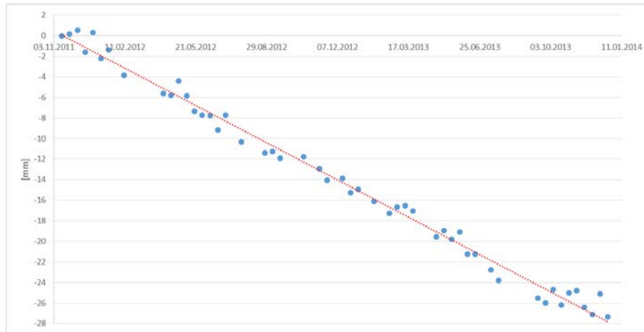
Abbildung 185: Zeitserie der 39 PSI-Punkte vom Ascending Datensatz Orbit Track 116 (Blickrichtung Osten) vom Hangfuß der Rutschung Cochem (Mittelwert und lineare Trendlinie).
