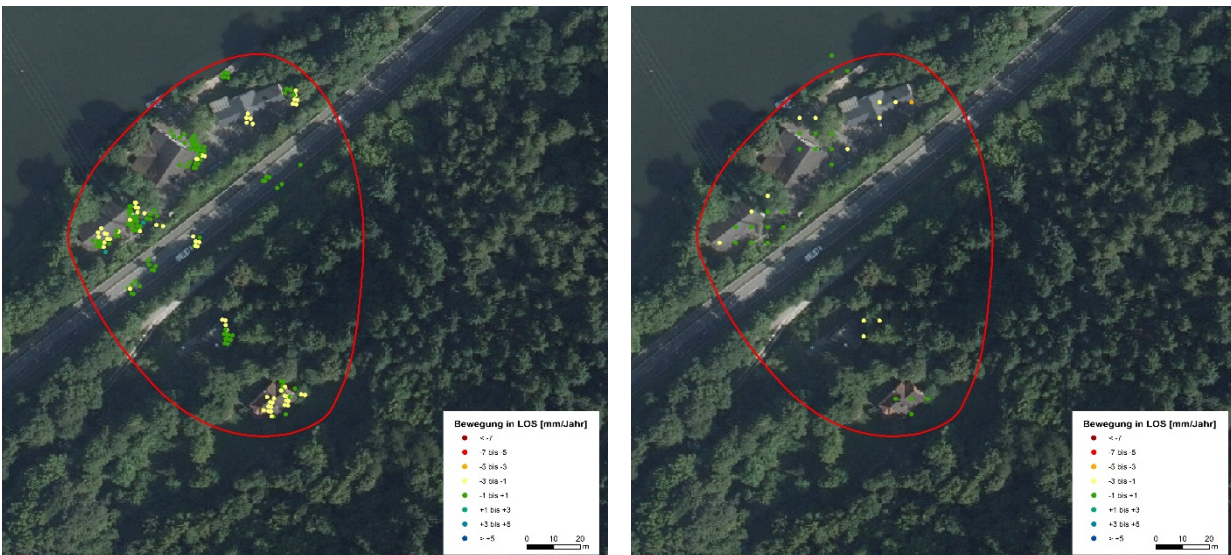
Abbildung 166: PSI- (links) und SBAS-Punkte (rechts) von Track 154 für den ausgewählten Bereich am Hangfuß (Hintergrund: DOP40, BKG).
