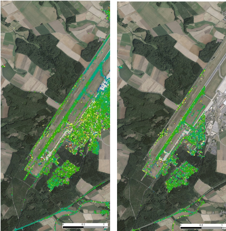
Abbildung 47: Überprüfung der Geokodierung der PSI-Daten (Track 116 links und Track 154 rechts) am Flughafen Frankfurt-Hahn (Hintergrund: DOP40).
