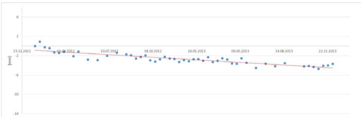
Abbildung 77: Zeitserie des Mittelwerts der SBAS-Daten für Bewegungsgebiet 4 (blaue Punkte) mit linearer Trendlinie (rote Linie).
