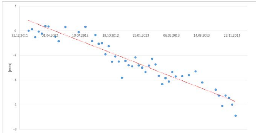
Abbildung 127: Zeitserie des Mittelwerts für 26 PSI-Punkte von Track 154 für Standort 1 (blaue Punkte) mit linearer Trendlinie (rote Linie).
