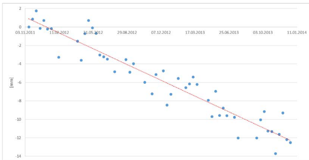
Abbildung 142: Zeitserie des Mittelwerts der 7 PSI-Punkte von Track 116 (blaue Punkte) mit linearer Trendlinie (rote Linie).
