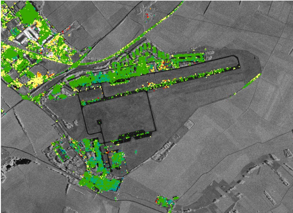
Abbildung 40: Überprüfung der Geocodierung der SBAS-Daten am Mendiger Flugplatz (Hintergrund: Amplitudenbild TSX).
