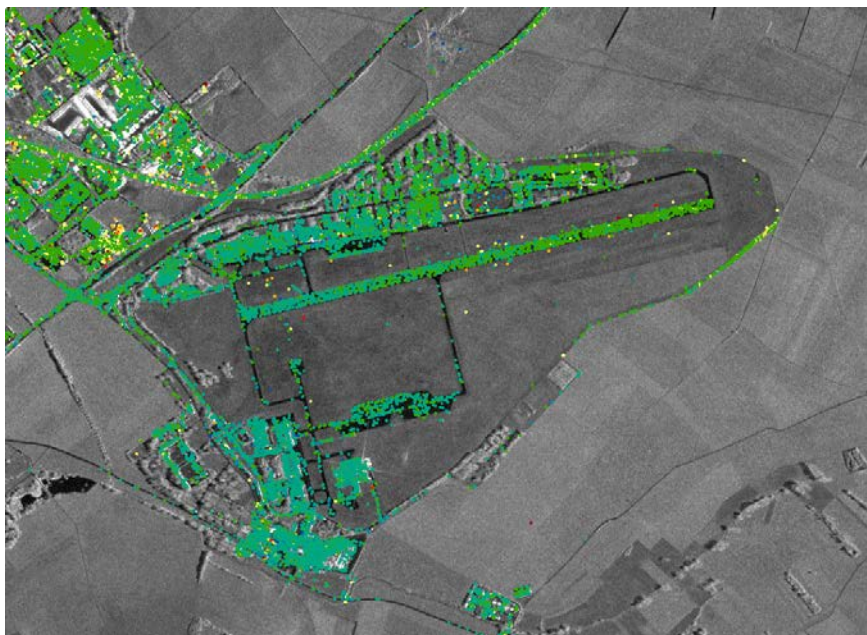
Abbildung 39: Überprüfung der Geokodierung der PSI-Daten am Mendiger Flugplatz (Hintergrund: Amplitudenbild TSX).
