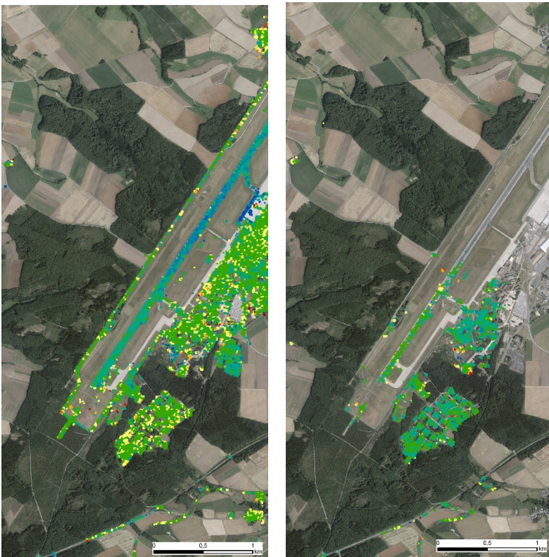
Abbildung 48: Überprüfung der Geokodierung der SBAS-Daten (Track 116 links und Track 154 rechts) am Flughafen Frankfurt-Hahn (Hintergrund: DOP40).
