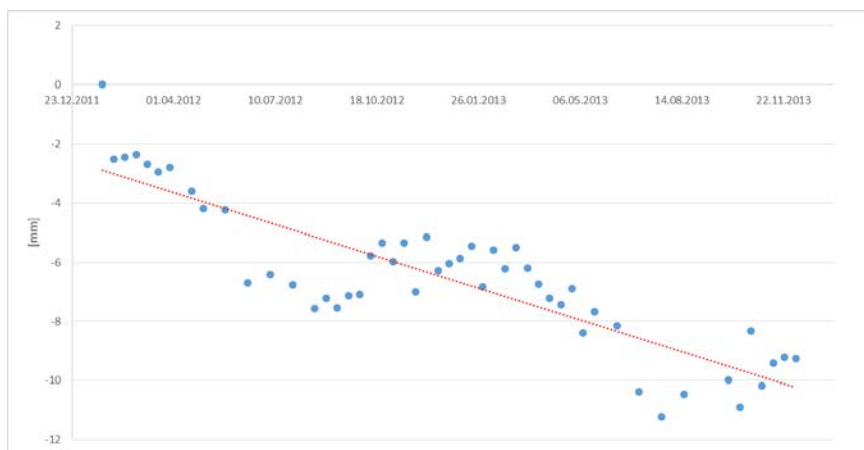
Abbildung 131: Zeitserie des Mittelwerts für 77 SBAS-Punkte von Track 154 für Standort 2 (blaue Punkte) mit linearer Trendlinie (rote Linie).
