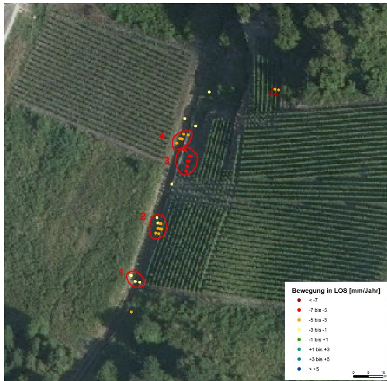
Abbildung 155: Ausgewählte Bewegungsgebiete für die Zeitreihenanalyse (PSI-Daten von Track 154).
