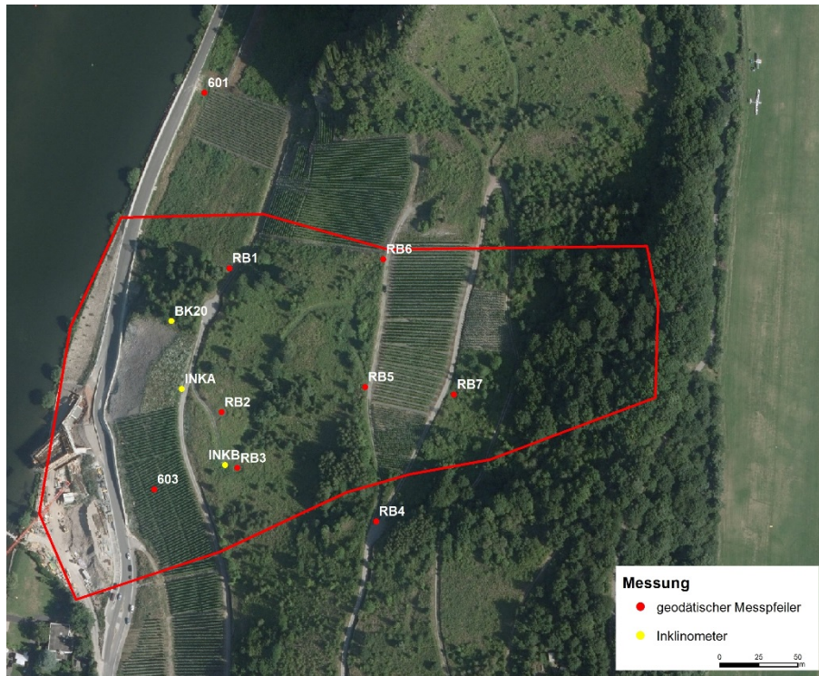
Abbildung 157: Lage der Messpfieiler und Inclinometer (abgeleitet aus „Überwachungsnetz Rißbach Stand 10/2013“) in der Rutschmasse (rote Linie) am Hang nördlich von Rißbach.
