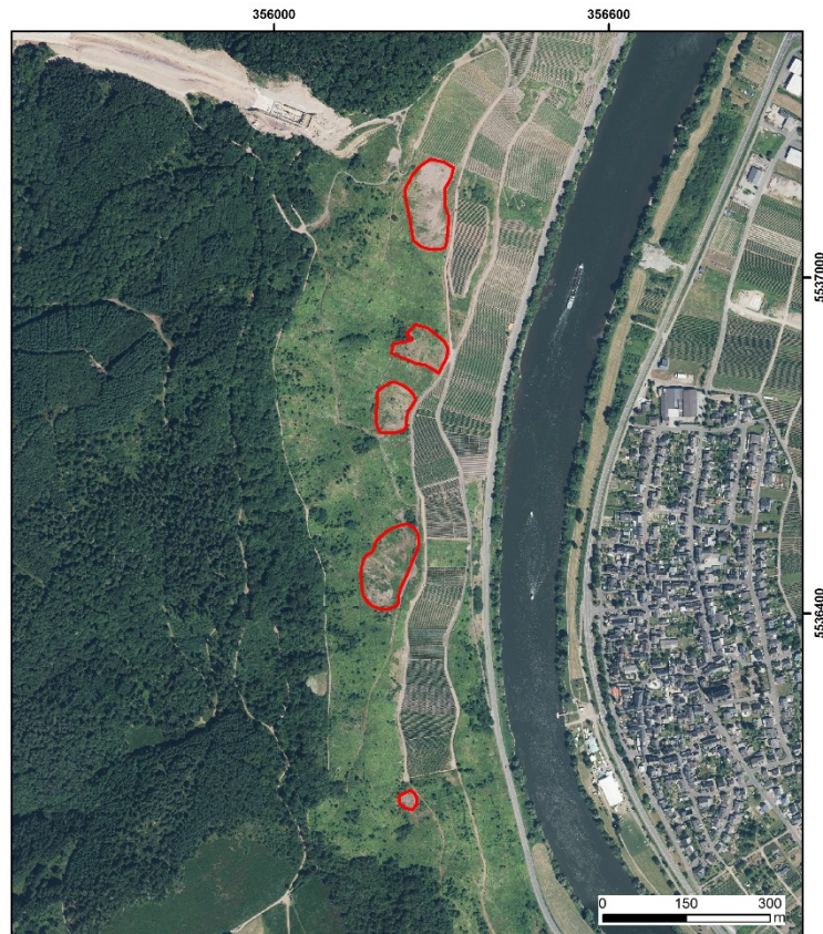
Abbildung 139: Kartierung auffälliger Hangbereiche (vegetationsarme Bereiche, rote Polygone) im Maßstab 1:5.000 aus dem Luftbild DOP40 (BKG, Aufnahme vom 20.7.2013).
