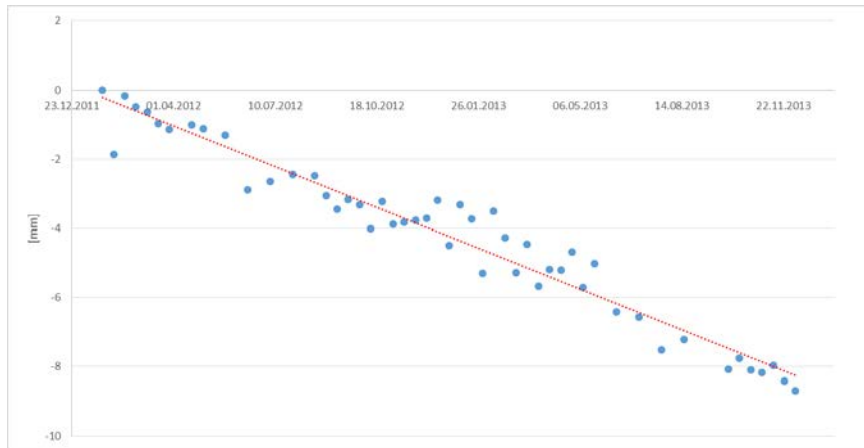
Abbildung 130: Zeitserie des Mittelwerts für 283 PSI-Punkte von Track 154 für Standort 2 (blaue Punkte) mit linearer Trendlinie (rote Linie).
