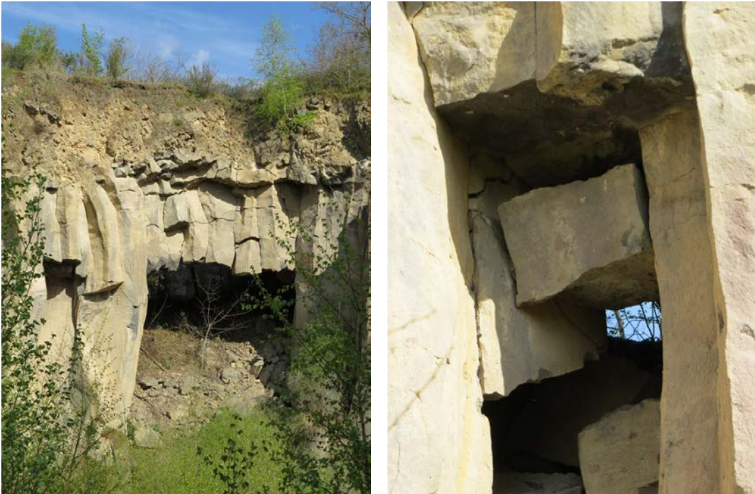
Abbildung 186: Gelockerte und absturzgefährdete Glocken im Mayener Grubenfeld am Rand des untersuchten Tagebruches (Foto: C. Wolf, April 2015).
