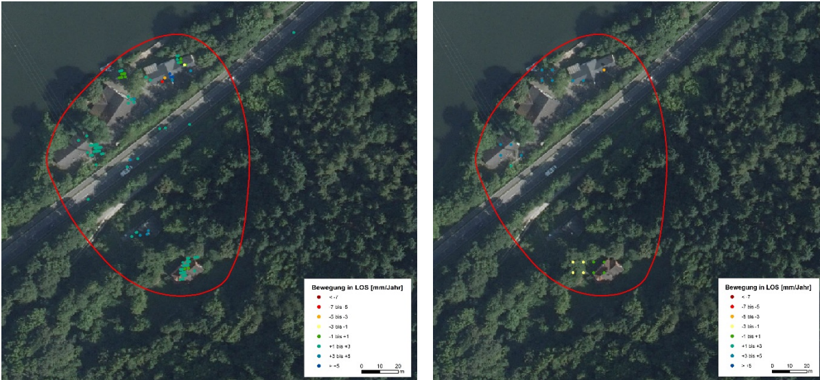
Abbildung 165: PSI- (links) und SBAS-Punkte (rechts) von Track 116 für den ausgewählten Bereich am Hangfuß (Hintergrund: DOP40, BKG).
