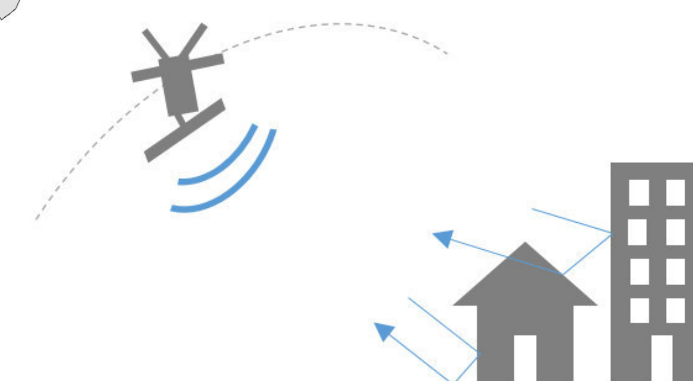
Abb. 2: Reflexion des Radarsignals an stabilen Objekten der Erdoberfläche, sogenannte Persistent Scatterer (PS), typische Reflektoren sind z.B. Gebäude, Anlagen, Brücken, Strommasten und Felsen.
