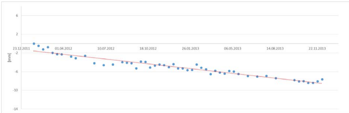
Abbildung 72: Zeitserie des Mittelwerts der SBAS-Daten für Bewegungsgebiet 1 (blaue Punkte) mit linearer Trendlinie (rote Linie).
