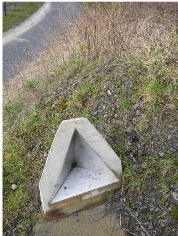
Abbildung 118: Corner Reflektor im Hang bei Graach (Foto: C. Wolf, Februar 2014).
