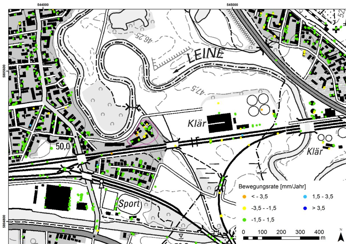
Abbildung 23: PSI-Bewegungsdaten zwischen 1992 und 2000 mit Umriss des Polygons „PGGH\_Hannover\_003“ (Topographische Karte 1:25.000, WGS84, UTM32N, BKG).
