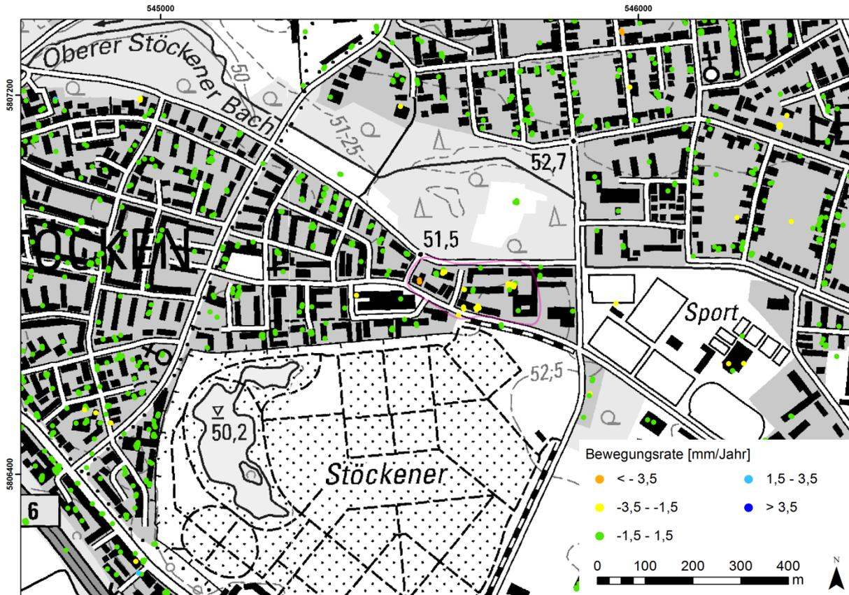
Abbildung 28: PSI-Bewegungsdaten zwischen 1992 und 2000 mit Umriss des Polygons „PGGH\_Hannover\_004“ (Topographische Karte 1:25.000, WGS84, UTM32N, BKG).
