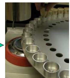
Zurückwiegen der Tiegel und Berechnung des Glühverlustes
