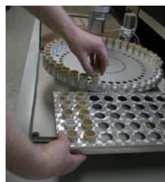
Auswiegen der Tiegel
