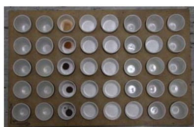
Mischen von Probe und Flussmittel
