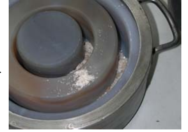
Mahlen in einer Scheibenschwingmühle
