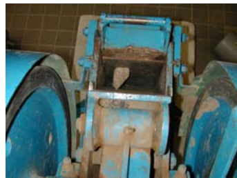
Grobzerkleinerung im Brecher
