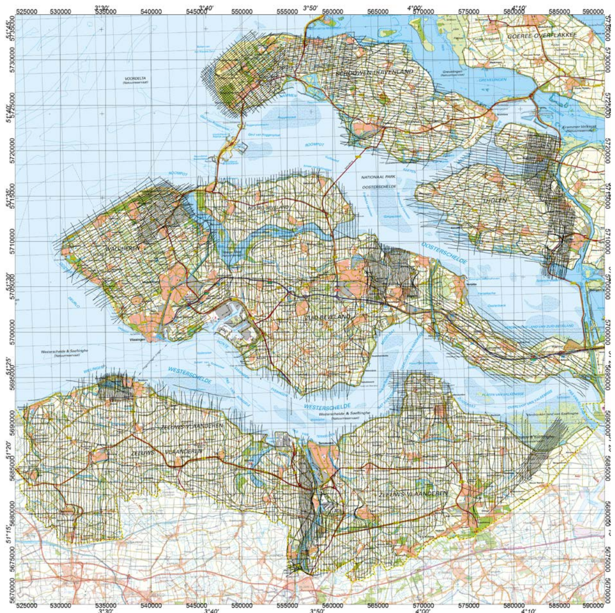
Abbildung 2: Fluglinienkarte (Ist-Fluglinien) für die Messgebiete in der Provinz Zeeland; Hintergrund: Georeferenzierte Rasterdaten der topografischen Karte 1:100.000 (Kadaster, 2016).
