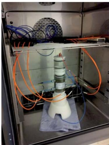
➤ Probenmaterial: Mischungen aus Feinsand und 6% Pyrit (P6Q-fein: <63 µm, P6Q-grob: 630 – 1000 µm), reales Haldenmaterial (S-P3a)
