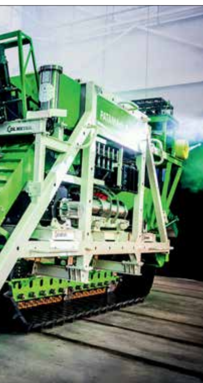
Abbildung 5: Prototyp eines selbstfahrenden Kollektors des belgischen Unternehmens DEME-GSR zum Abbau von Manganknollen in der Tiefsee im Testmaßstab. Der Prototyp hat die Abmessungen 10 x 4,7 x 4,5 m (L x B x H) und ein Gewicht von 35 t in Luft. Er soll im Einsatz eine Geschwindigkeit von mindestens 0,5 m pro Sekunde erreichen.
