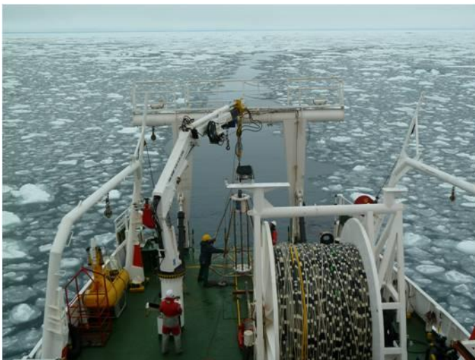
Die Wärmestromsonde wird nach erfolgreichem Einsatz an Deck gehievt
